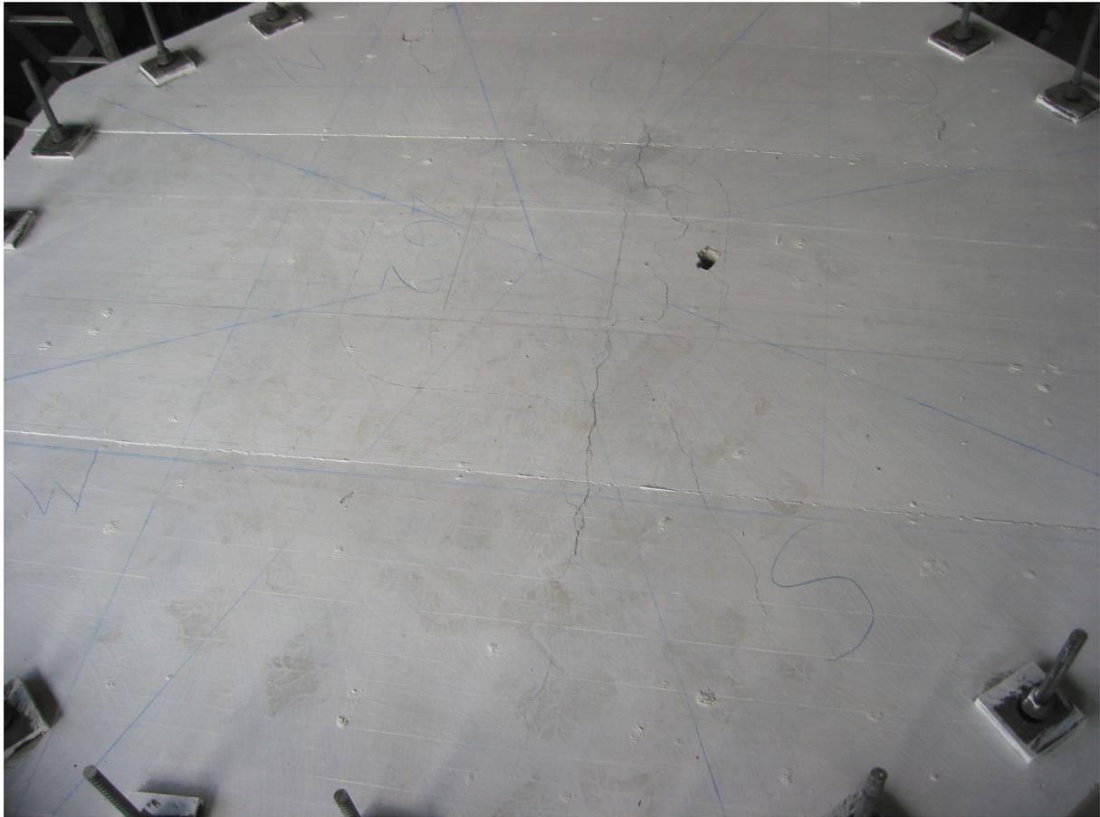
*Bild 4.68:* Plattenoberseite nach dem Versagen
