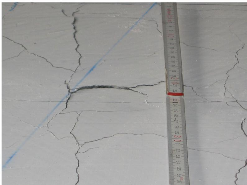
*Bild 4.125:* Betonscholle im Bereich des kritischen Rundschnitts
