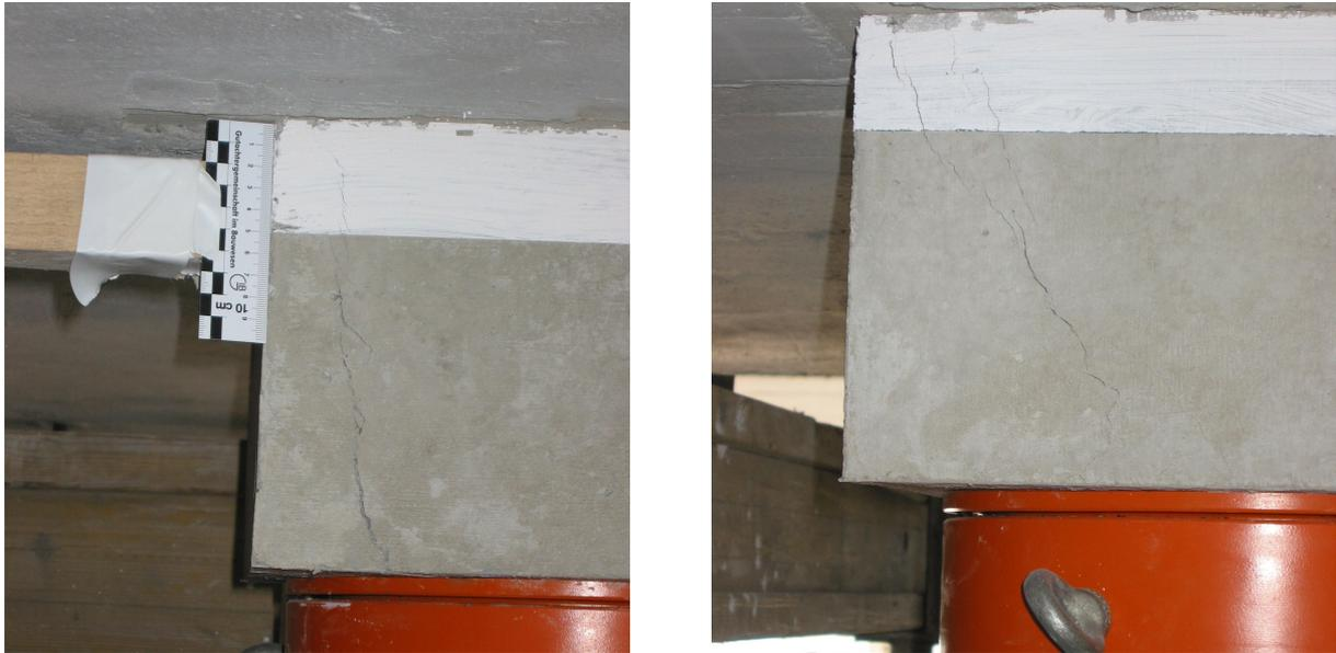
**Bild 5.126:** Krafteinleitungsrisse im Stützenstumpf bei 2.000 kN
