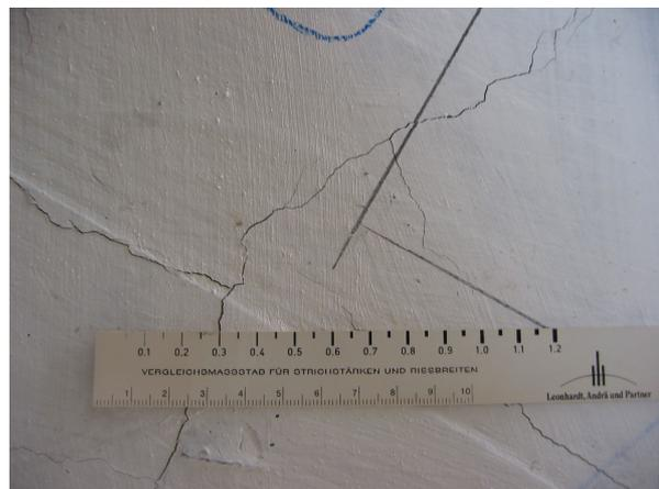
**Bild 4.51:** Rissweiten im Bereich des Stützenstumpfs bei einer Last von 544 kN
