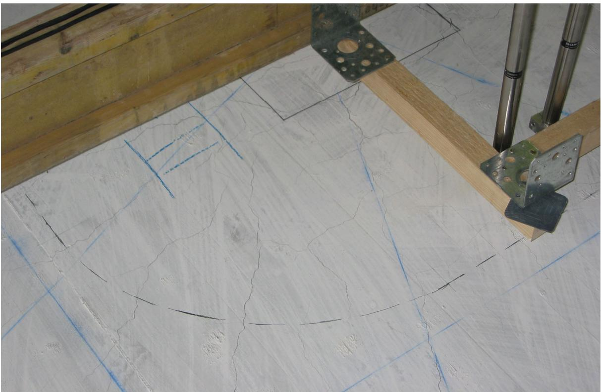
**Bild 5.77:** Rissbild im Süd-West-Sektor bei der 17. Laststufe
