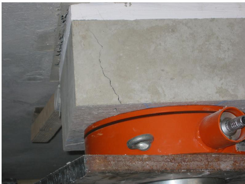
*Bild 5.137:* Stützenstumpf nach dem Versagen mit Kräfteinleitungsrissen
