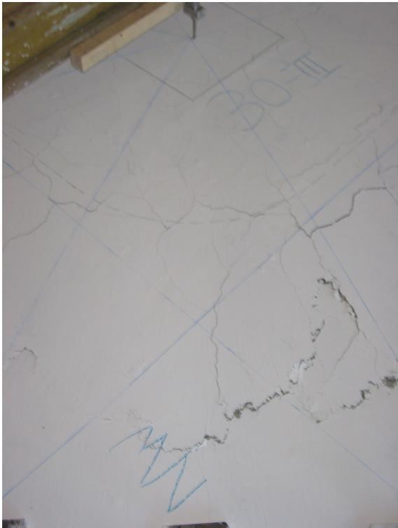
*Bild 5.133:* Nord-West-Sektor kurz nach dem Versagen
