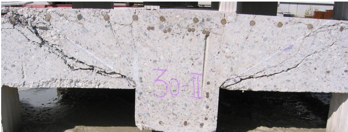
**Bild 5.91:** Schnittfläche der zweiten 30 cm starken Versuchsplatte
