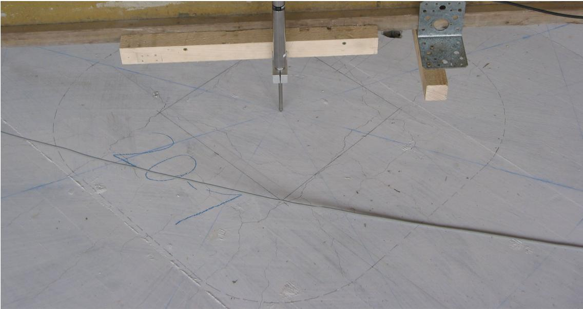
**Bild 4.16:** Risse im Stützenbereich bei Gebrauchslastniveau
