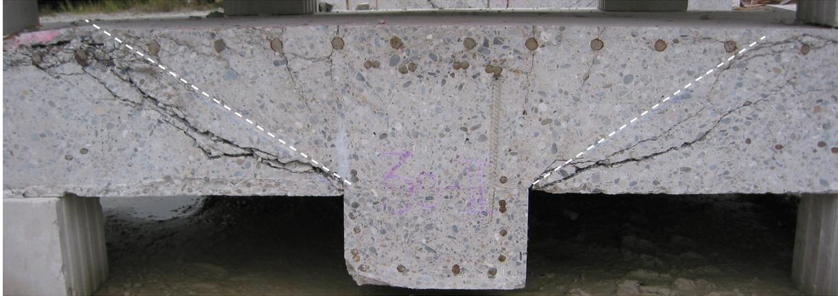
*Bild 5.88:* Aufgezeichnete 1 zu 2 Linie an der Schnittfläche der Platte 30-II
