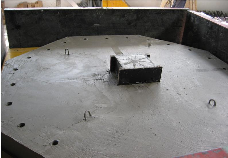
*Bild 4.86:* Ausgeschaltete Versuchsplatte mit Ermittlung des Mittelpunkts
