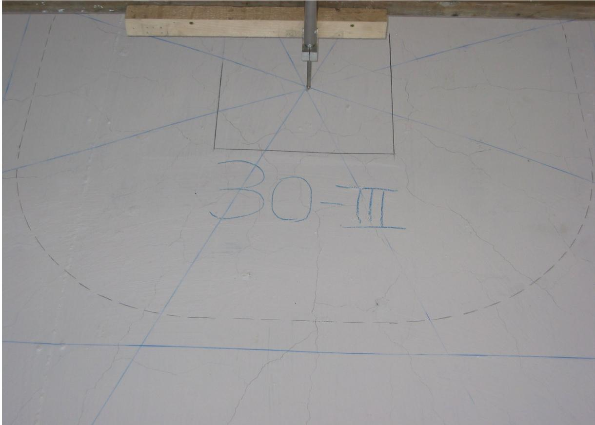
**Bild 5.107:** Westliche Plattenhälfte bei einer Last von 1.395 kN
