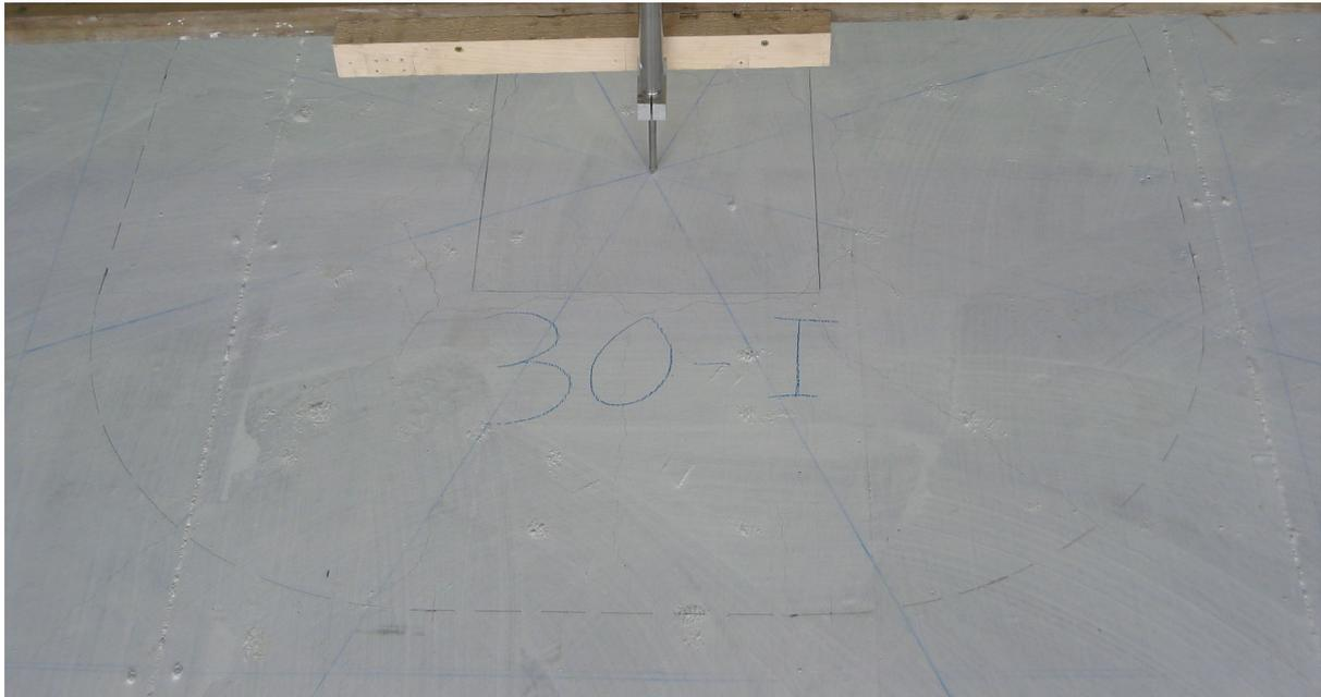
**Bild 5.10:** Rissbild im Bereich des Stützenstumpfs bei einer Last von 803 kN
