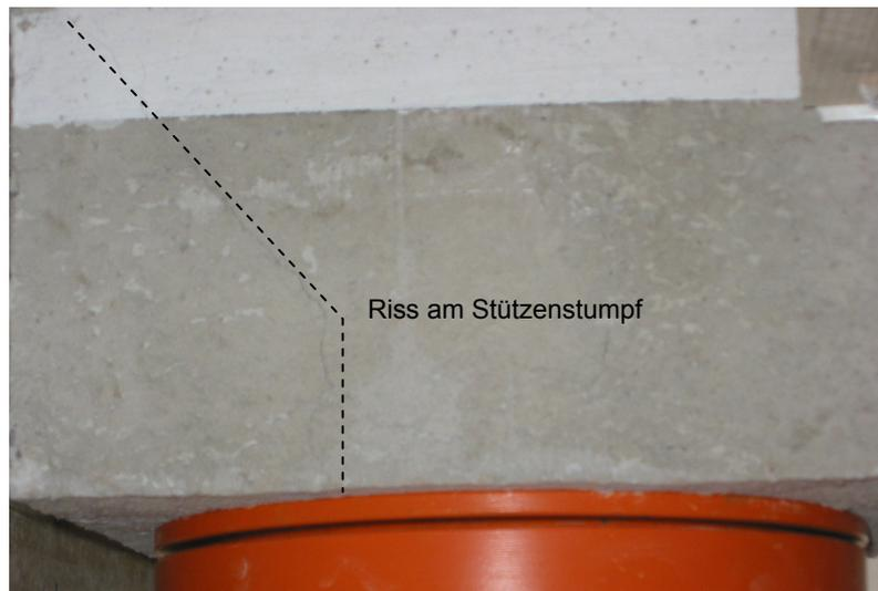
*Bild 4.104:* Krafteinleitungsriss am Stützenstumpf
