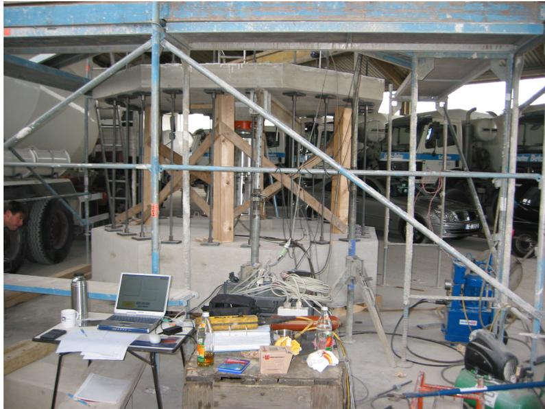
**Bild 4.12:** Arbeitsplatz mit Rechner und Messverstärker
