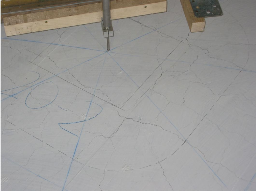
*Bild 4.59* Rissbild an der Plattenoberseite bei 96 % der theoretischen Bruchlast
