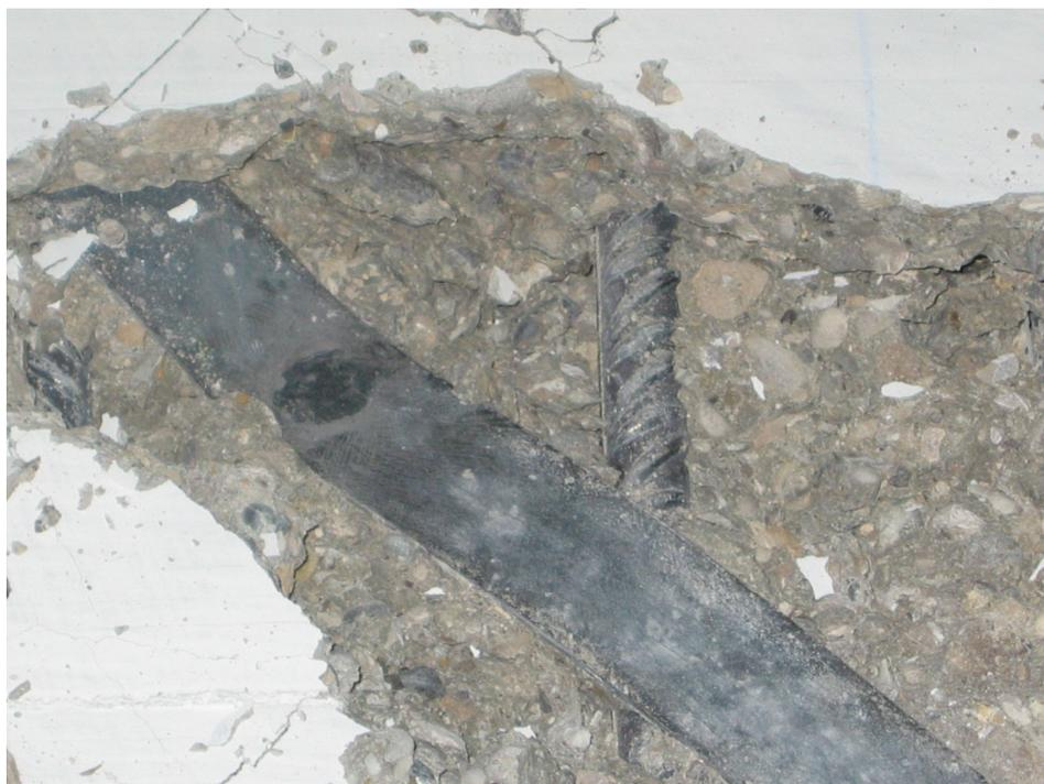
**Bild 5.38:** HFV-Ankerleiste nach dem Bruch
