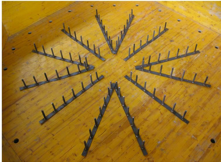
*Bild 4.1:* Näherungsweise rotationssymmetrisch verlegte HFV-Anker
