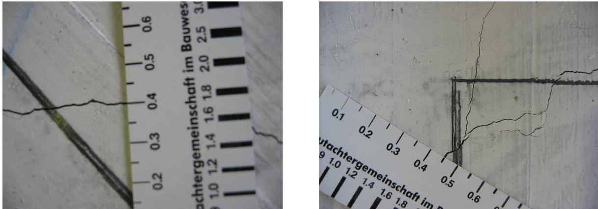
**Bild 5.57:** Gemessene Rissweiten bei Gebrauchslast
