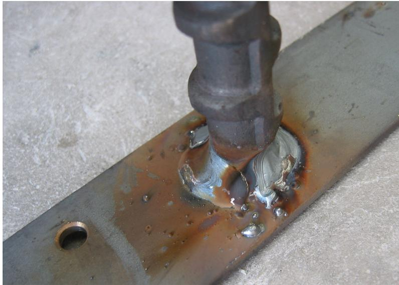
**Bild 3.18:** Schweißnaht am HFV-Anker
