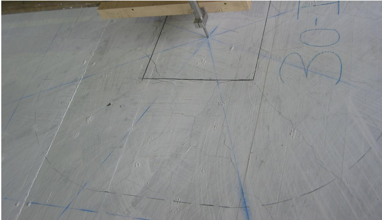
**Bild 5.65:** Rissbild im nördlichen Bereich des Stützenstumpfs bei 1.389 kN
