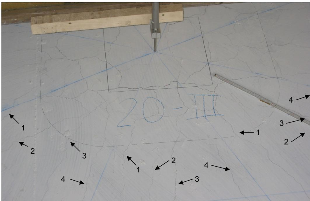
**Bild 4.114:** Rissbild im Stützenbereich bei 96 % der rechnerischen Bruchlast (936 kN)
