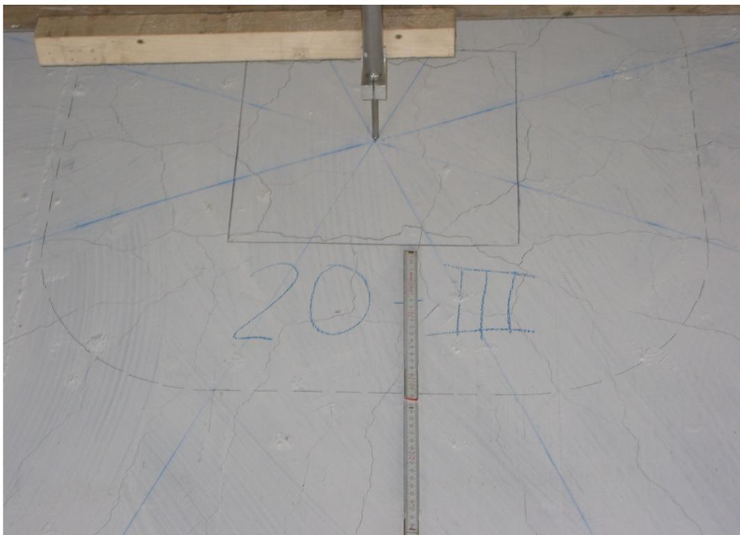
**Bild 4.107:** Rissbild im Bereich des Stützenstumpfs bei einer Last von 800 kN
