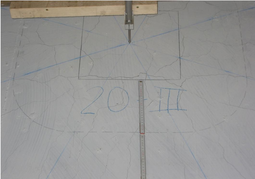
**Bild 4.111:** Rissbild im Stützenbereich bei 900 kN
