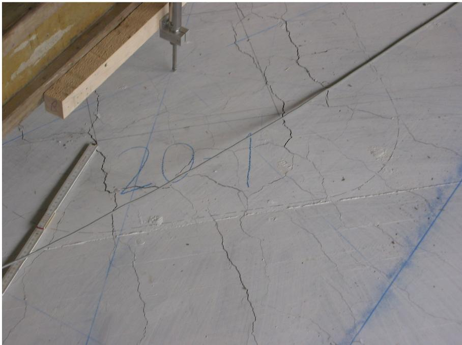
*Bild 4.21:* Rissbild im Stützenbereich nach dem Versagen der Platte 20-I
