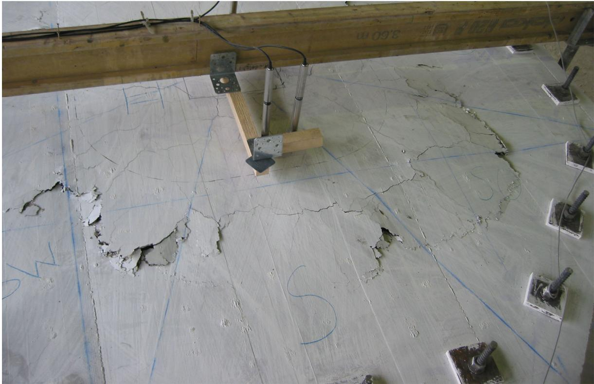
*Bild 5.82:* Südliche Plattenhälfte nach dem Versagen
