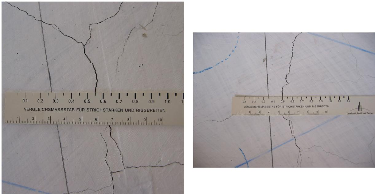
**Bild 4.54:** Maximale Rissweiten im Stützenbereich bei 650 kN
