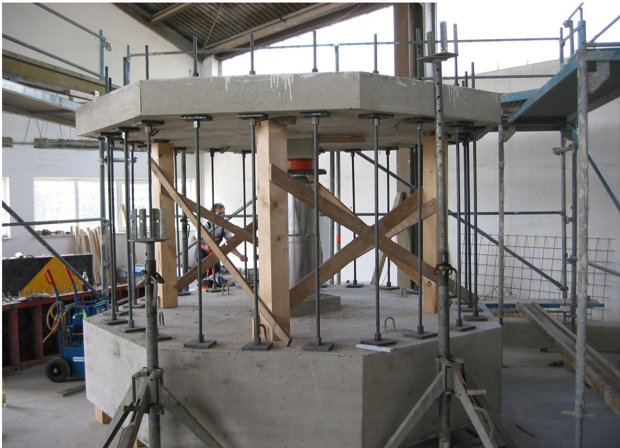
**Bild 1.1:** Versuchsstand für Durchstanzversuche
