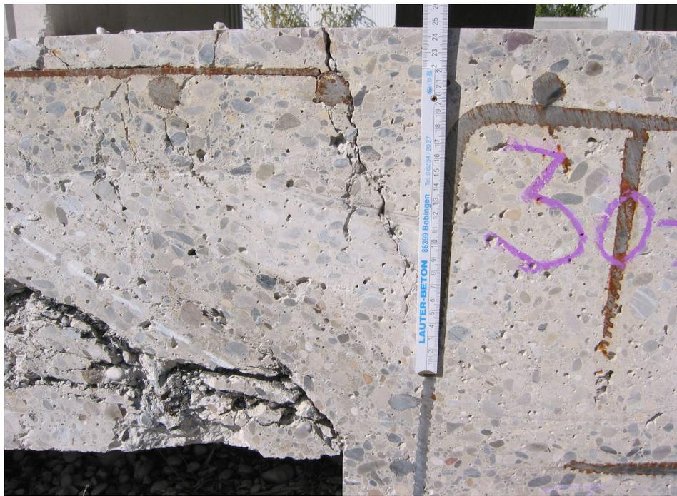
**Bild 5.45:** Gemessene maximale Risttiefe im Stützenstumpfbereich
