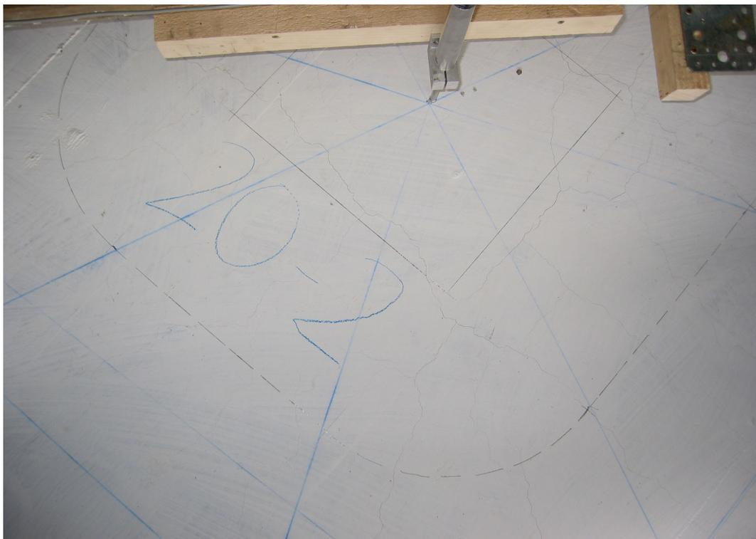
**Bild 4.47:** Rissbild unmittelbar um die Stütze an der Plattenoberseite
