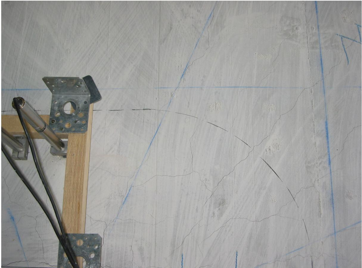
**Bild 5.73:** Risse im süd-westlichen Sektor um den Stützenstumpf bei 1.590 kN
