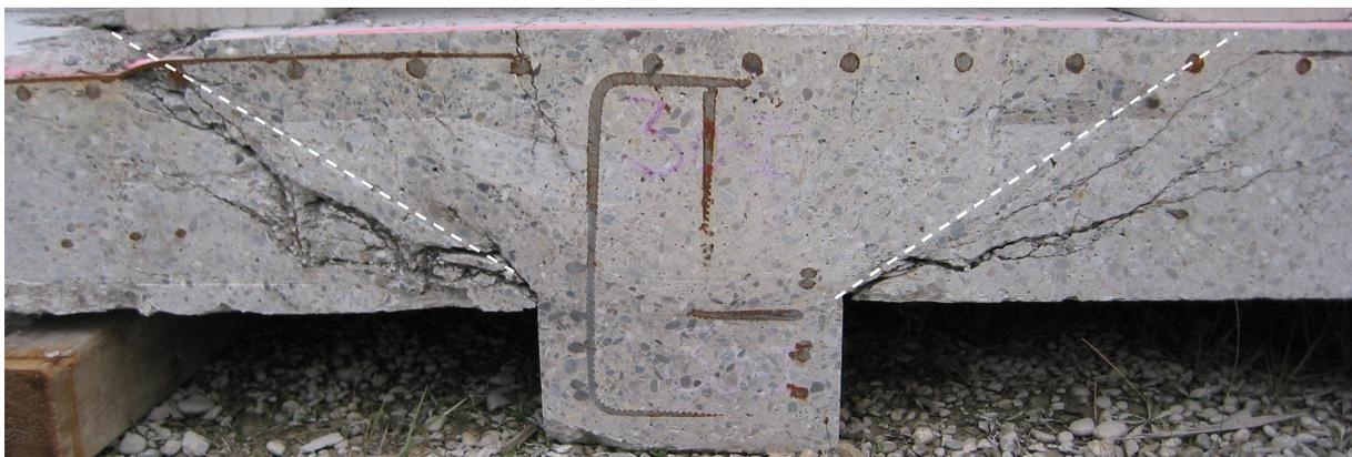
**Bild 5.43:** Aufgetragener Durchstanzkegel auf die Schnittfläche der Platte 30-I
