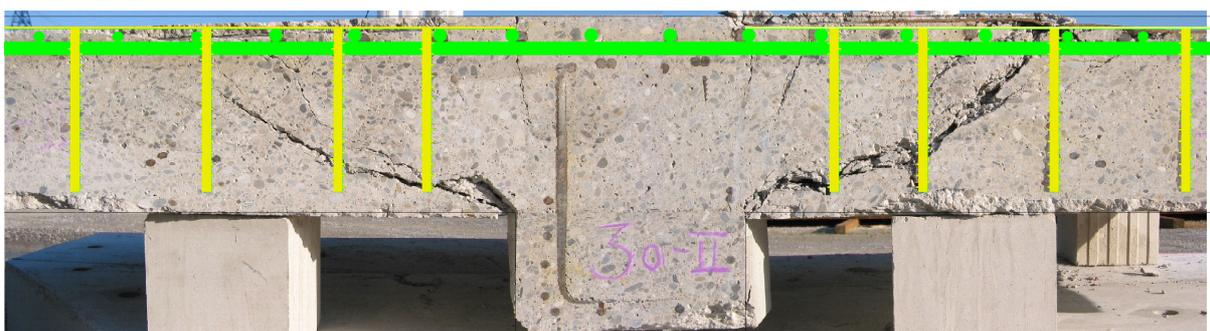
**Bild 5.87:** Schnittfläche mit eingezeichneter Biegebewehrung und HFV-Ankern
