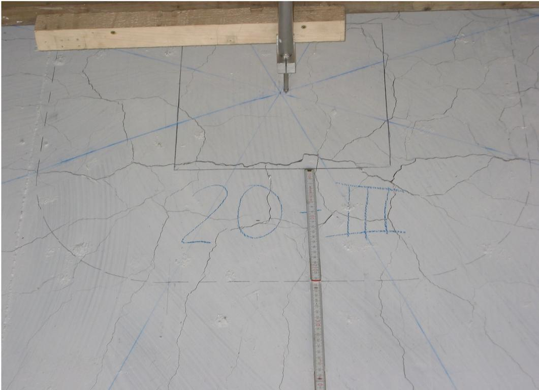
**Bild 4.126:** Rissbild der dritten Versuchsplatte nach dem Bruch
