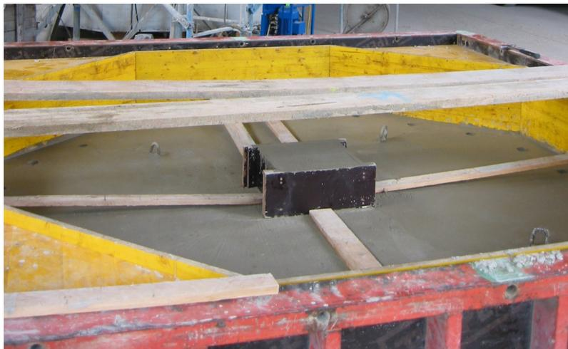
*Bild 4.85:* Fertig betonierte Versuchsplatte 20-III
