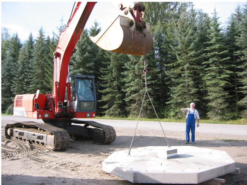
*Bild 4.87:* Drehen der dritten Versuchsplatte mit Hilfe eines Baggers
