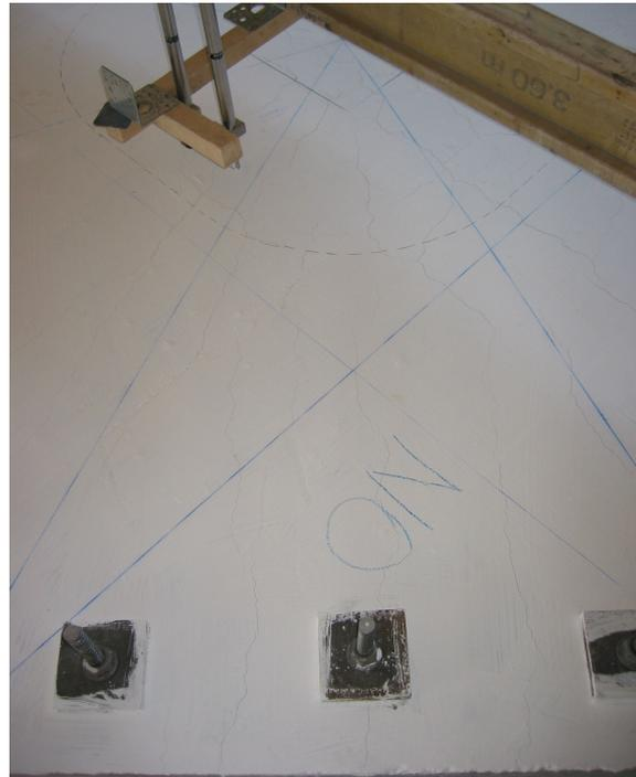
**Bild 5.121:** Risse im Nord- und Nord-Ost-Sektor bei 1.887 kN
