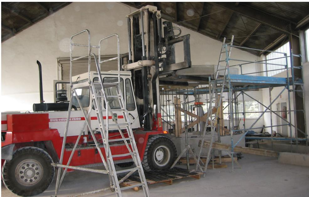
*Bild 6.3:* Auflegen der Platte auf den Versuchsstand mit Hilfe des Gabelstaplers
