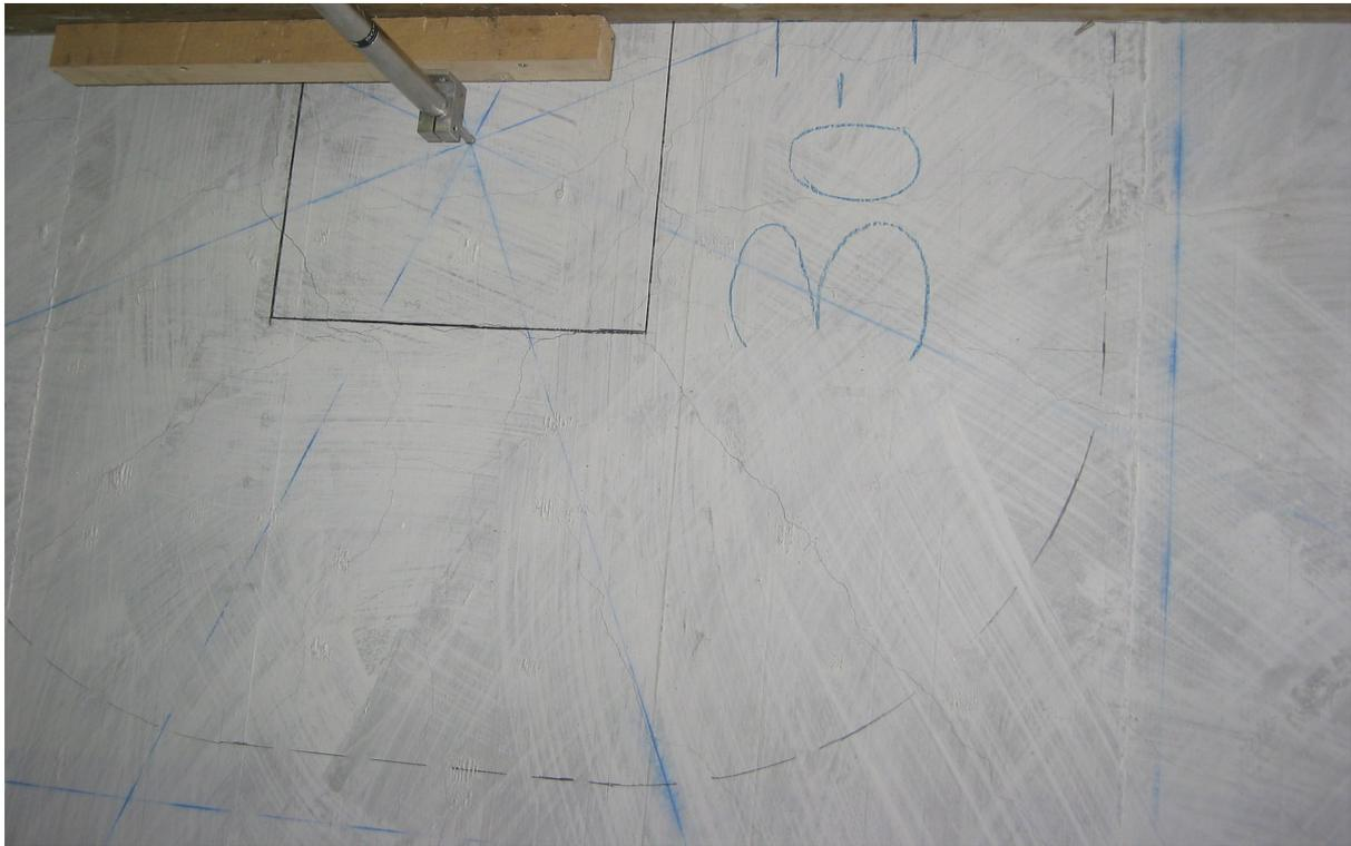
*Bild 5.55:* Rissbild im nördlichen Bereich des Stützenstumpfs in Höhe Gebrauchslast
