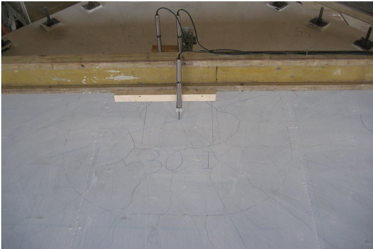
**Bild 5.31:** Risse in der westlichen Hälfte des Stützenstumpfs bei einer Last von 1.694 kN
