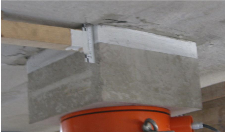
*Bild 4.66:* Eindringen des Stützenstumpfs in die Platte
