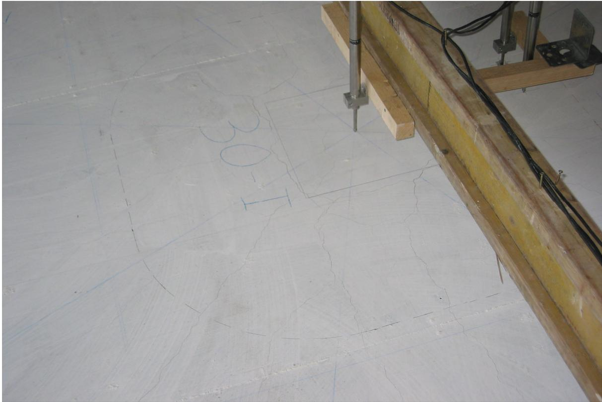
**Bild 5.19:** Risse im Bereich des Stützenstumpfs in der westlichen Hälfte
