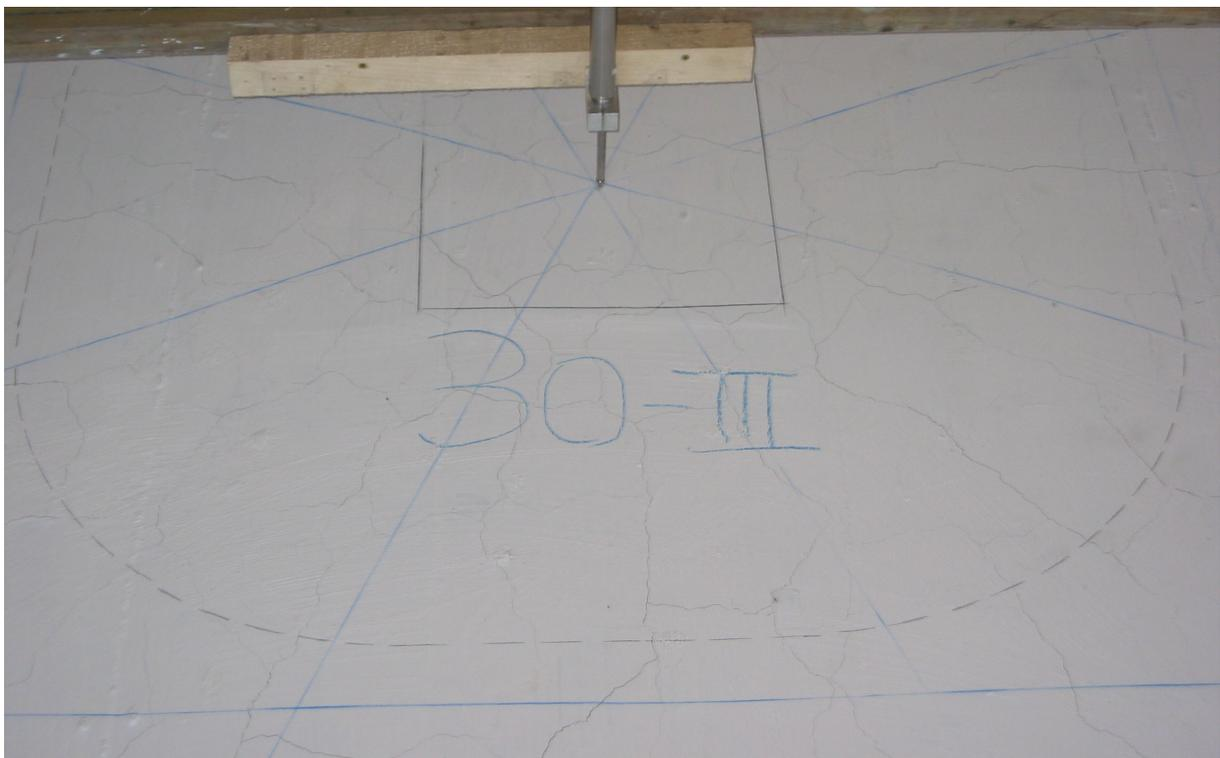
**Bild 5.127:** Rissbild der westlichen Plattenhälfte bei 2.000 kN
