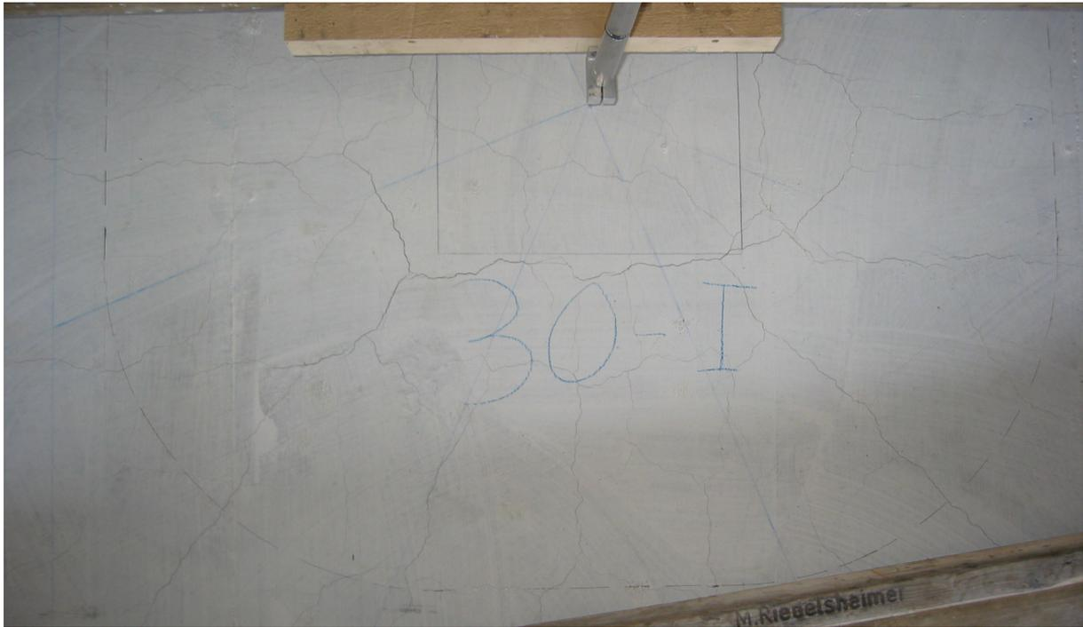
Bild 5.23: Rissbild im Bereich des Stützenstumpfs bei einer Last von 1.381 kN
