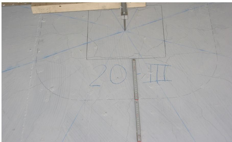
*Bild 4.105:* Rissverlauf im Stützenbereich bei einer Last von 748 kN
