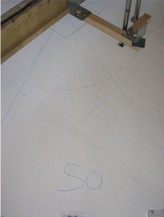
Bild 5.122: Rissbilder der Sektoren Ost und Süd-Ost bei 1.887 kN
