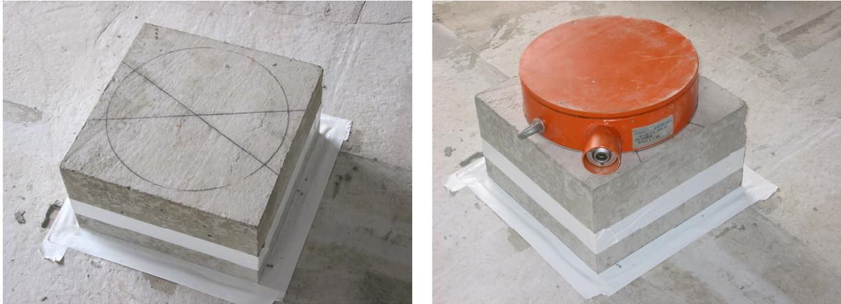
*Bild 4.36:* Stützenstumpf mit Solllage der Kraftmessdose
