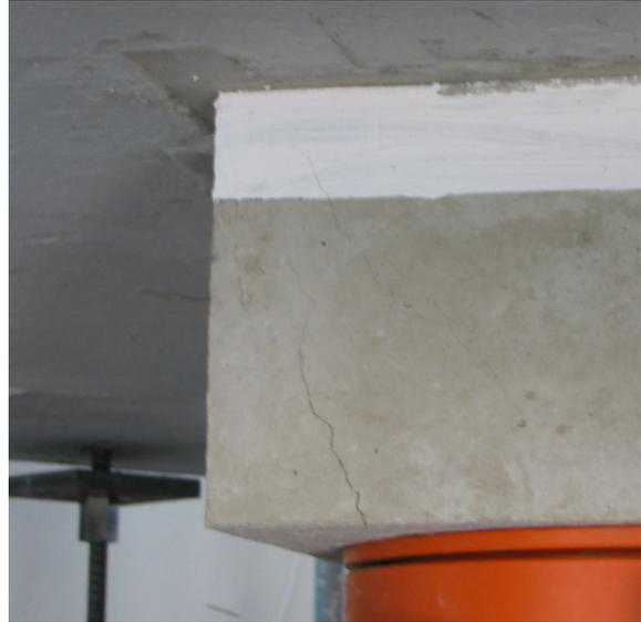
**Bild 5.120:** Krafteinleitungsrisse am Stützenstumpf bei einer Last von 1.887 kN
