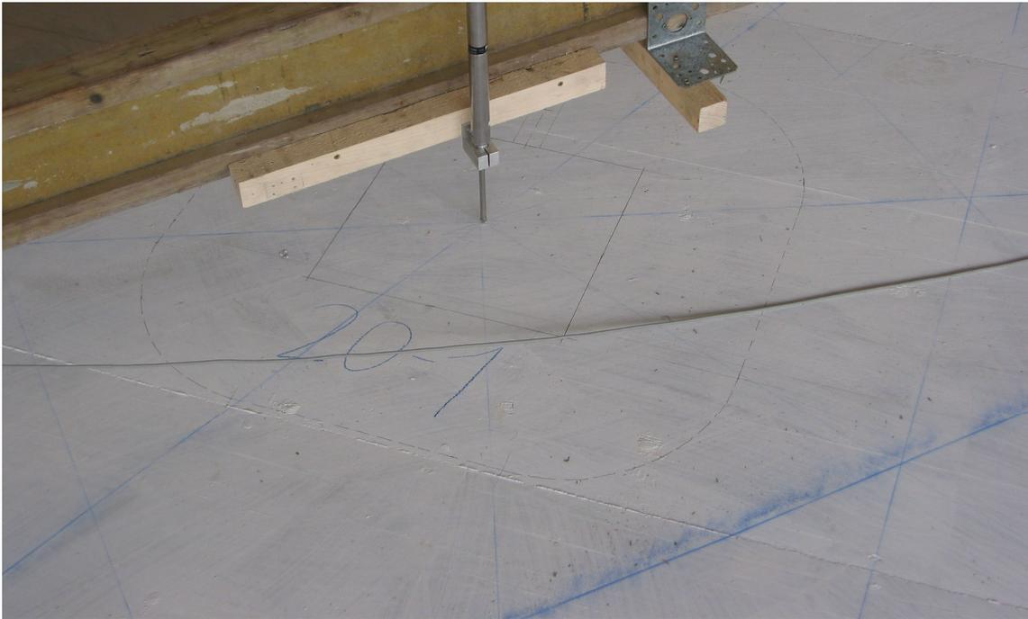
**Bild 4.14:** Risse im Stützenbereich bei 260 kN
