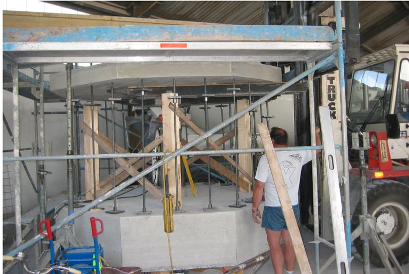
**Bild 4.40:** Auflegen der Platte 20-II auf den Versuchsstand
