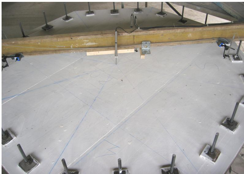
**Bild 4.41:** Plattenoberseite mit angebrachten Wegaufnehmern
