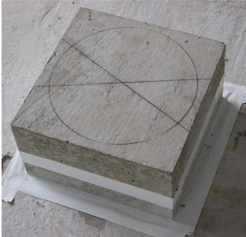
*Bild 4.6:* Stützenstumpf mit Mittelpunkt und Solllage der Kraftmessdose
