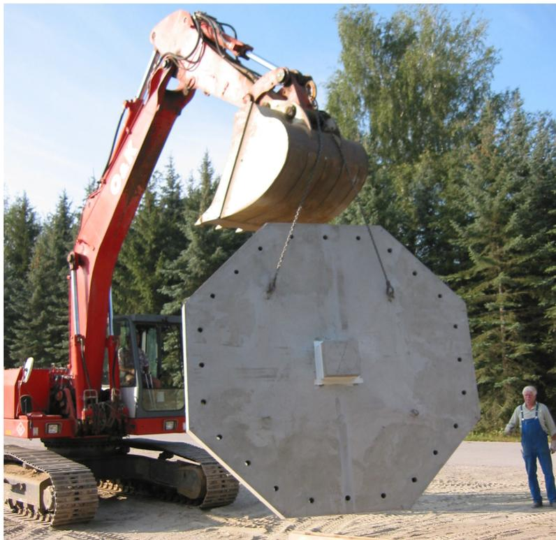
*Bild 4.37:* Drehen der zweiten Versuchsplatte vor dem Einbau auf den Versuchsstand
