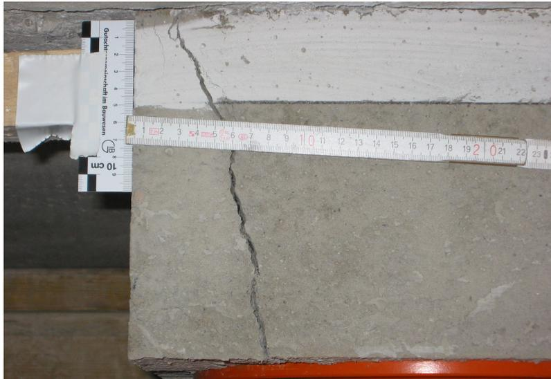
*Bild 4.120:* Krafteinleitungsriss im Stützenstumpf
