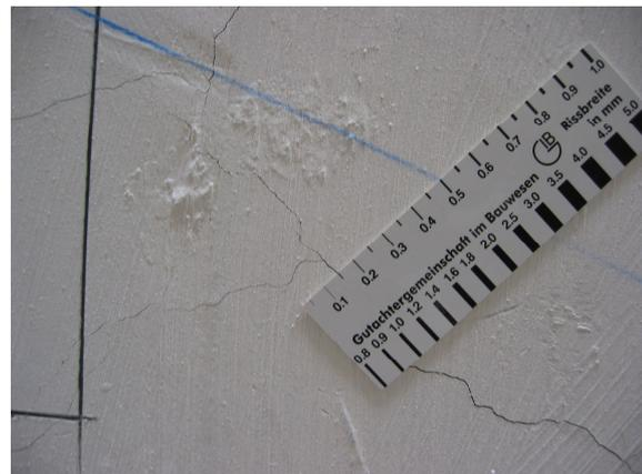
**Bild 5.101:** Gemessene Rissweiten im Bereich des Stützenstumpfs bei 994 kN
