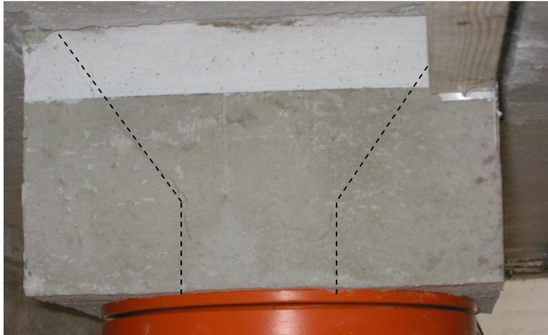
**Bild 4.106:** Krafteinleitungsrisse am Stützenstumpf
