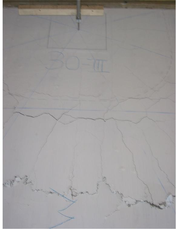
*Bild 5.132:* Süd-West- und West-Sektor kurz nach dem Versagen
