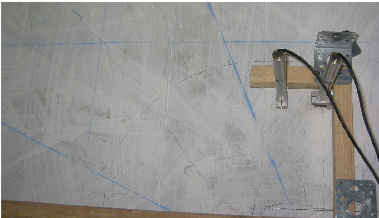
*Bild 5.72:* Risse im Süd-Ost-Sektor um den Stützenstumpf
