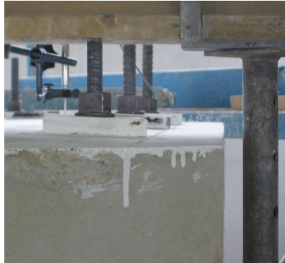
*Bild 5.16:* Risse im Stirnbereich und Verdrehung der Platte im Bereich der Verankerung
