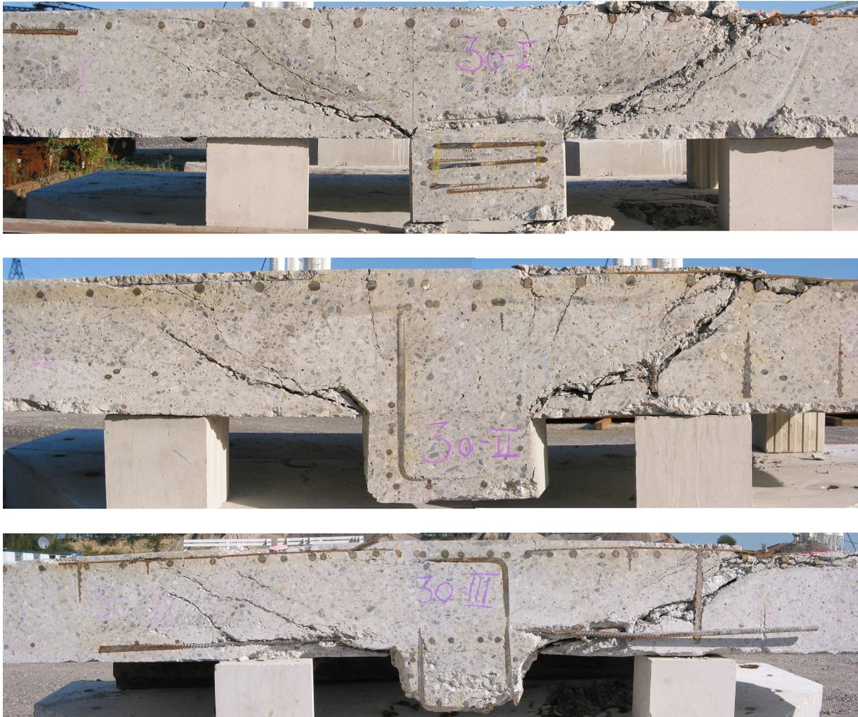
**Bild 5.146:** Schnittflächen der 30 cm starken Versuchsplatten
