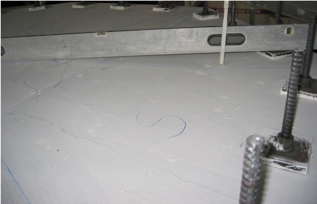
*Bild 4.132:* Durchbiegung nach dem Bruch gemessen mit einer Alulatte von 5,5 cm
