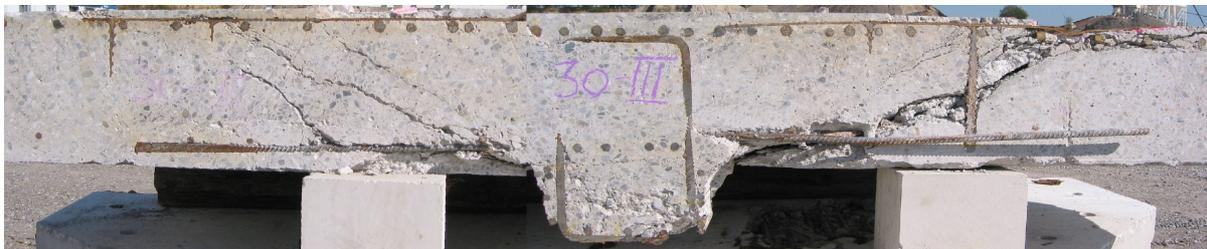
**Bild 5.140:** Schnittfläche der Versuchsplatte 30-III
