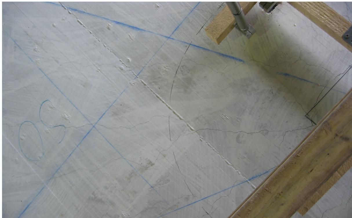
**Bild 5.66:** Risse im süd-östlichen Stützenstumpfbereich
