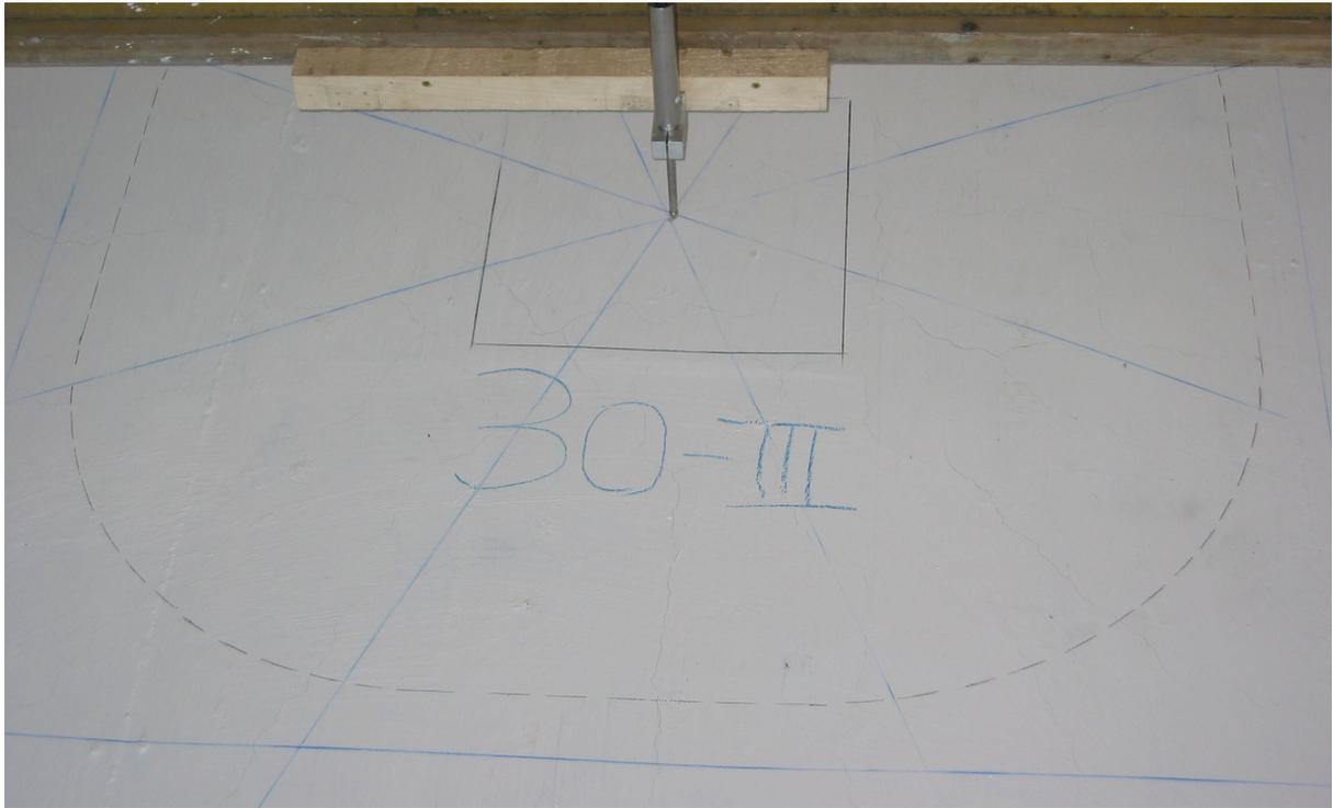
*Bild 5.102:* Rissbild der westlichen Hälfte des Stützenstumpfs bei 1.094 kN
