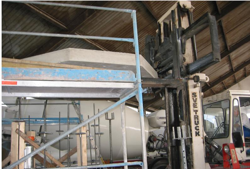
*Bild 4.88:* Auflegen der Platte auf den Versuchsstand
