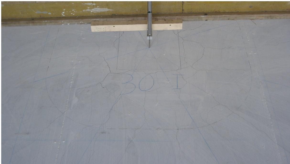
**Bild 5.30:** Rissbild im Bereich des Stützenstumpfs in der westlichen Hälfte
