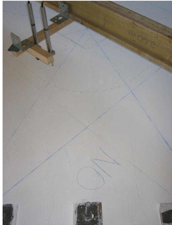
**Bild 5.111:** Risse im Nord- und Ost-Sektor bei 1.591 kN
