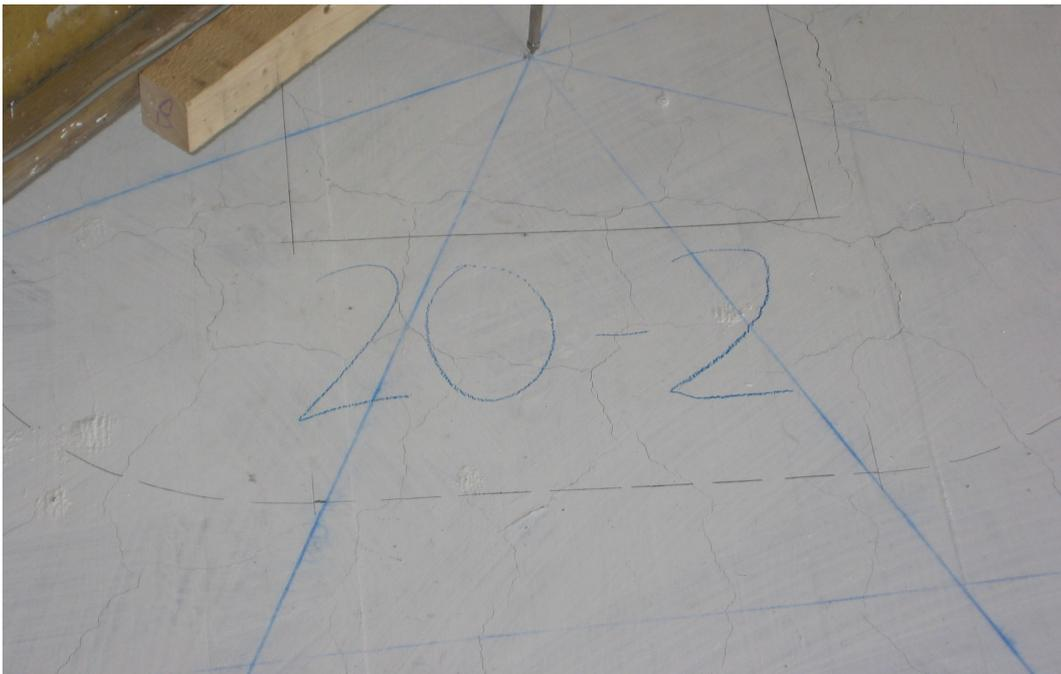
**Bild 4.55:** Risse im Bereich des Stützenstumpfs bei einer Last von etwa 700 kN
