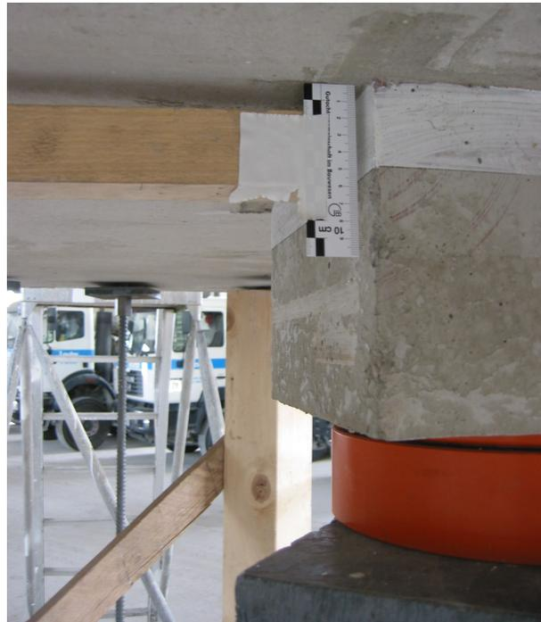
**Bild 4.42:** Angebrachtes Messlineal an der Plattenunterseite unmittelbar am Stützenstumpf
