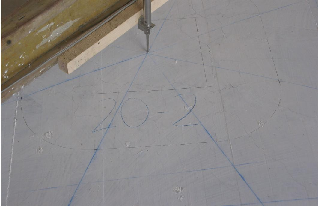
**Bild 4.52:** Rissbild im Stützenbereich bei der 12. Laststufe
