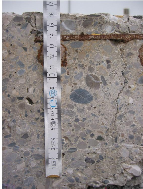
*Bild 4.77:* Maximale Risstiefe der Versuchsplatte 20-II
