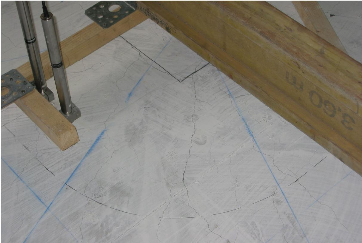
**Bild 5.76:** Kritischer Rundschnitt im Süd-Ost-Sektor bei 1.673 kN
