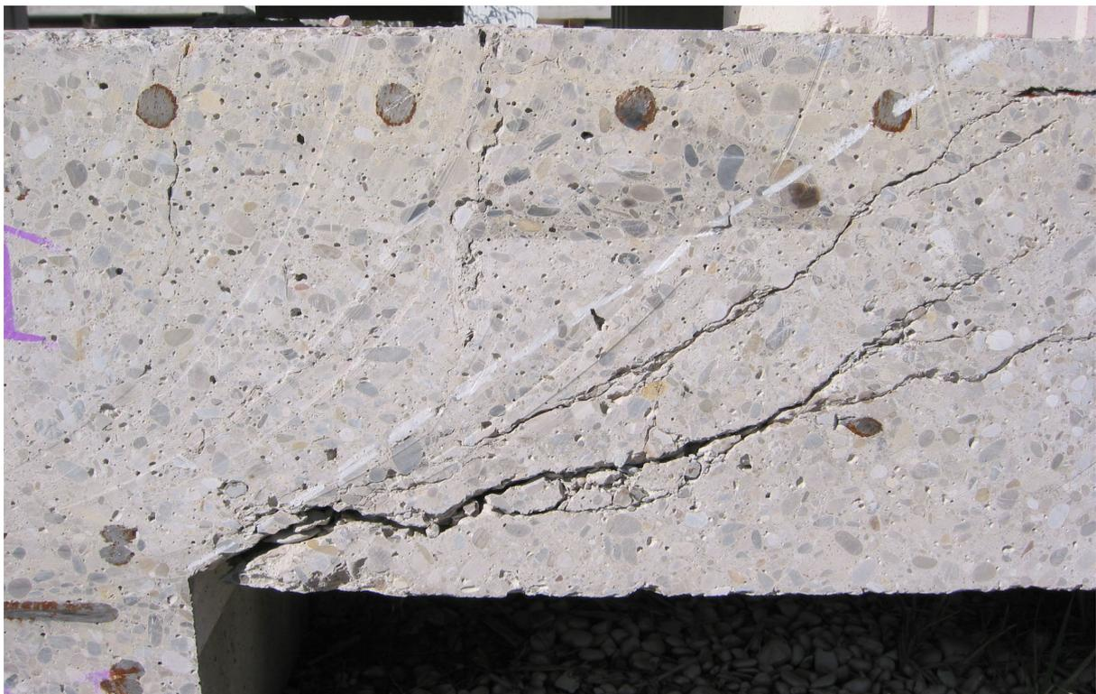
**Bild 5.47:** Zweite Hälfte der Schnittflächen der ersten 30 cm starken Versuchsplatte
