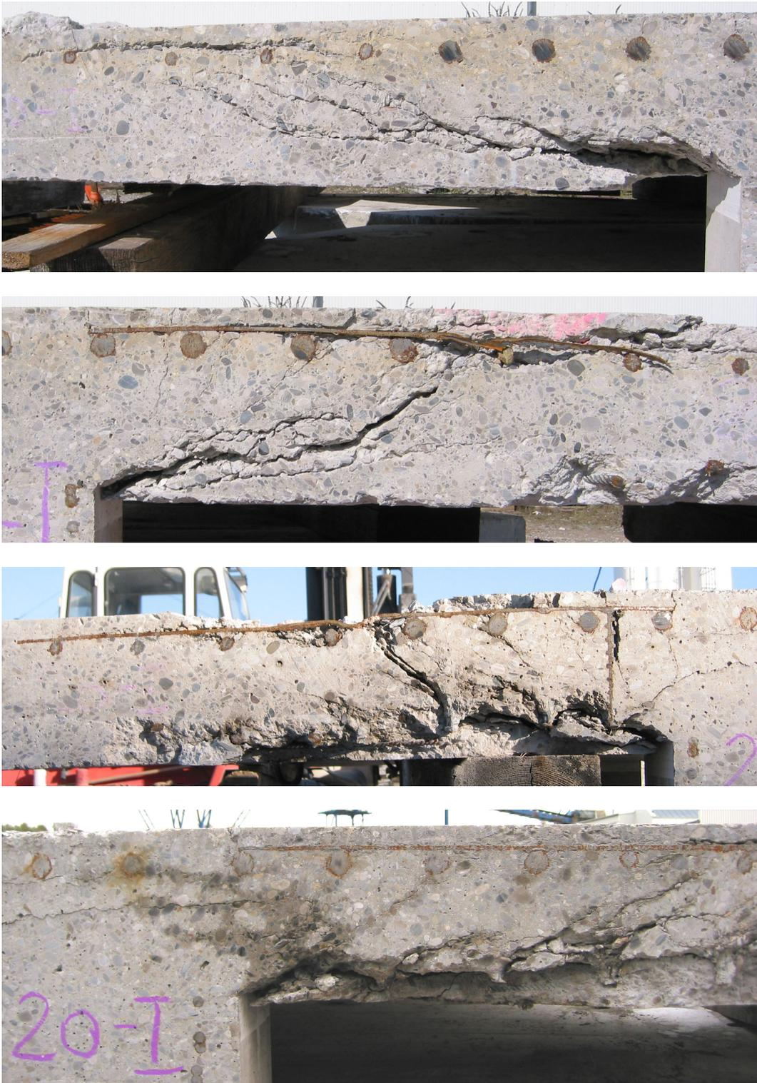
**Bild 4.32:** Schnittflächen der Versuchsplatte 20-I
