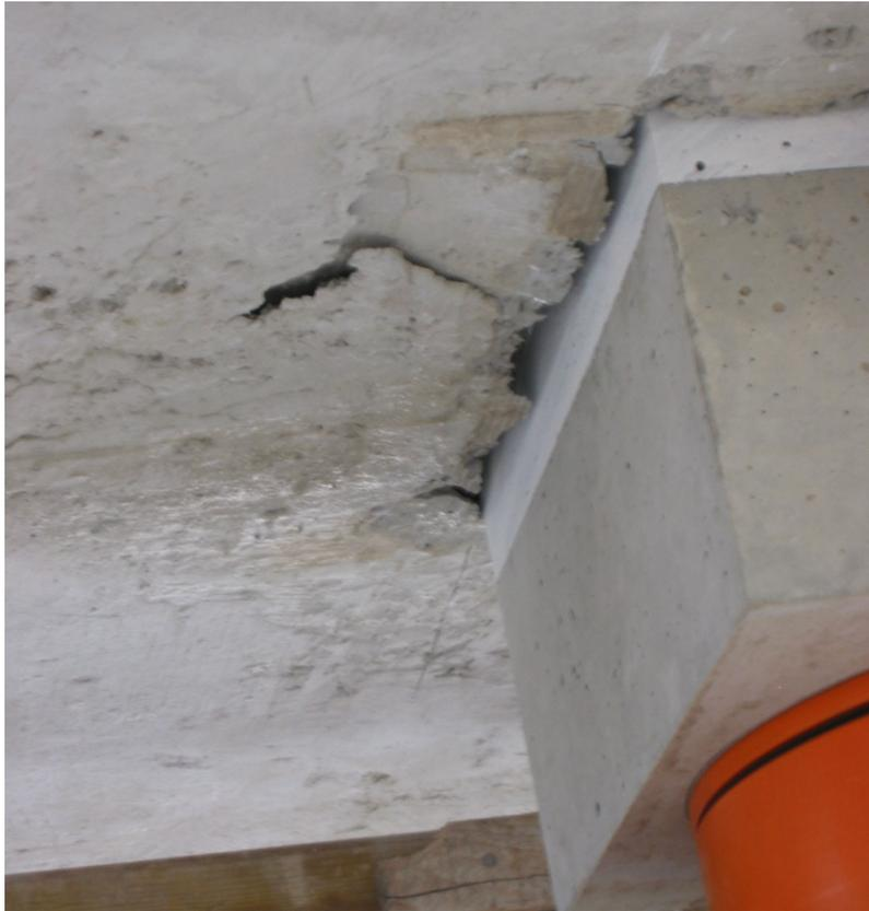
*Bild 4.24:* Bereich um den Stützenstumpf nach dem Versagen
