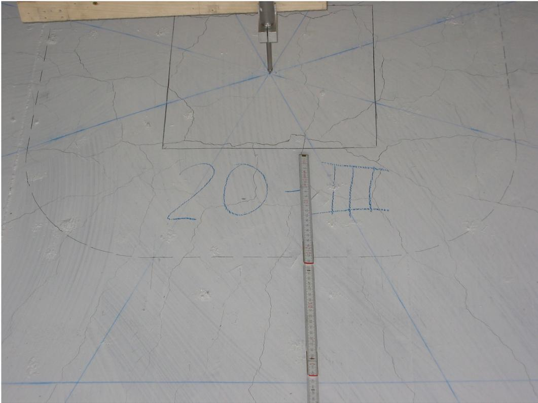
**Bild 4.109:** Rissbild im Bereich des Stützenstumpfs bei einer Last von 850 kN
