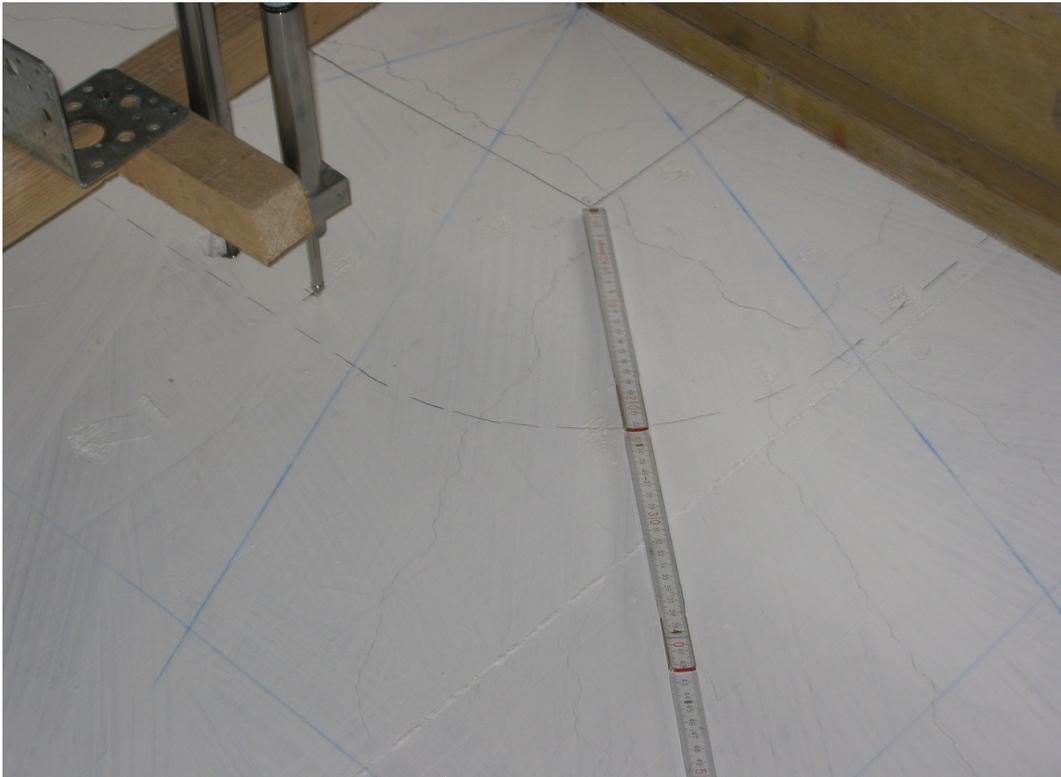
**Bild 4.95:** Rissbild im Bereich des Stützenstumpfs auf Gebrauchslastniveau
