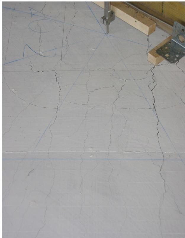
*Bild 4.71:* Risse im Süd-West-Sektor nach dem Versagen
