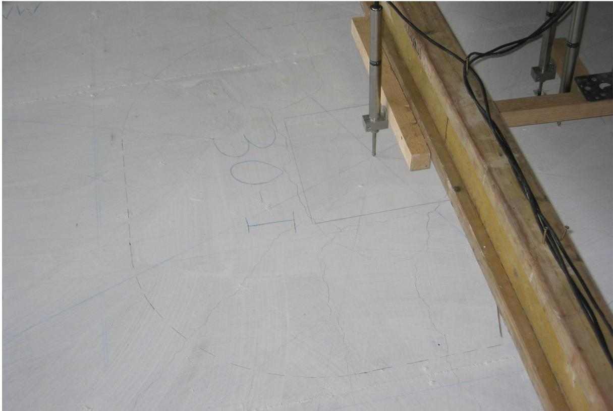
**Bild 5.17:** Rissbild im Bereich des Stützenstumpfs in der westlichen Hälfte bei 1.102 kN
