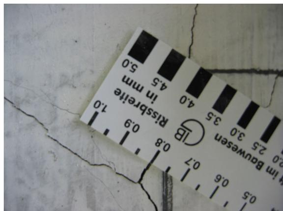
*Bild 5.68:* Gemessene Rissweiten im Bereich des Stützenstumpfs
