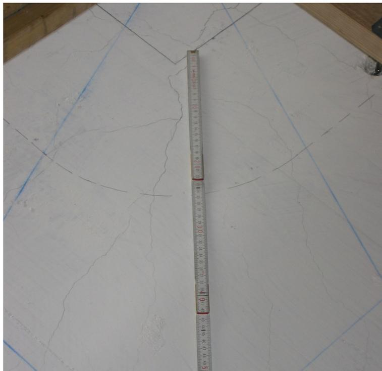
**Bild 4.96:** Risse im Nord-West-Sektor bei einer Last von 548 kN
