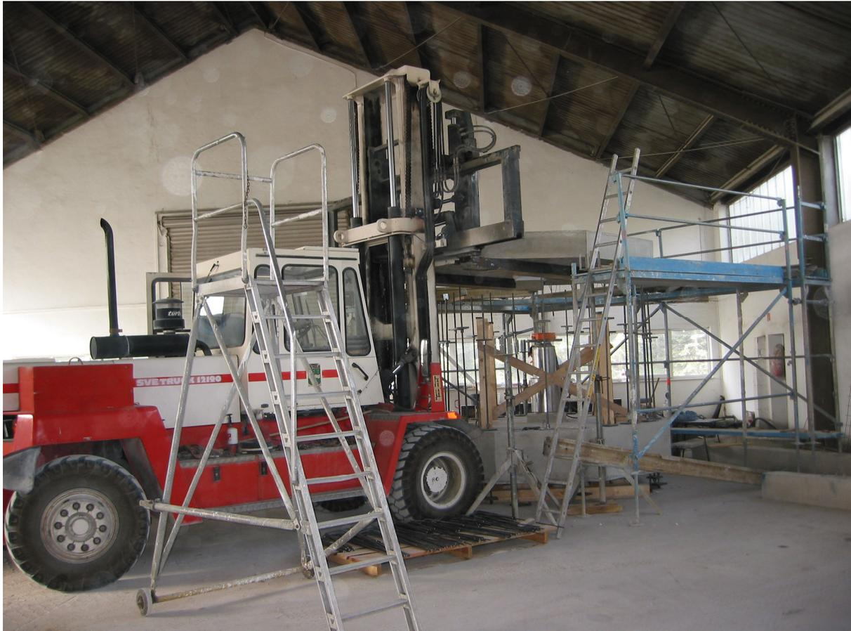
**Bild 5.51:** Auflegen der Versuchsplatte 30-II auf den Versuchsstand
