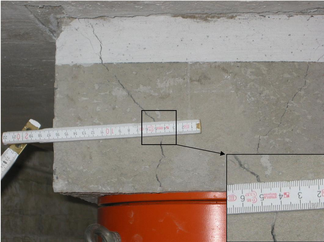
**Bild 4.119:** Stützenstumpf bei einer Last von 1.000 kN
