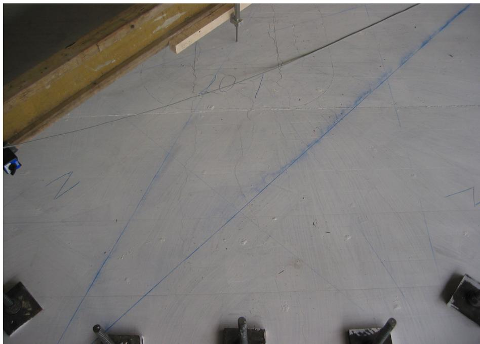
**Bild 4.17:** Plattenoberfläche bei einer Last von 630 kN
