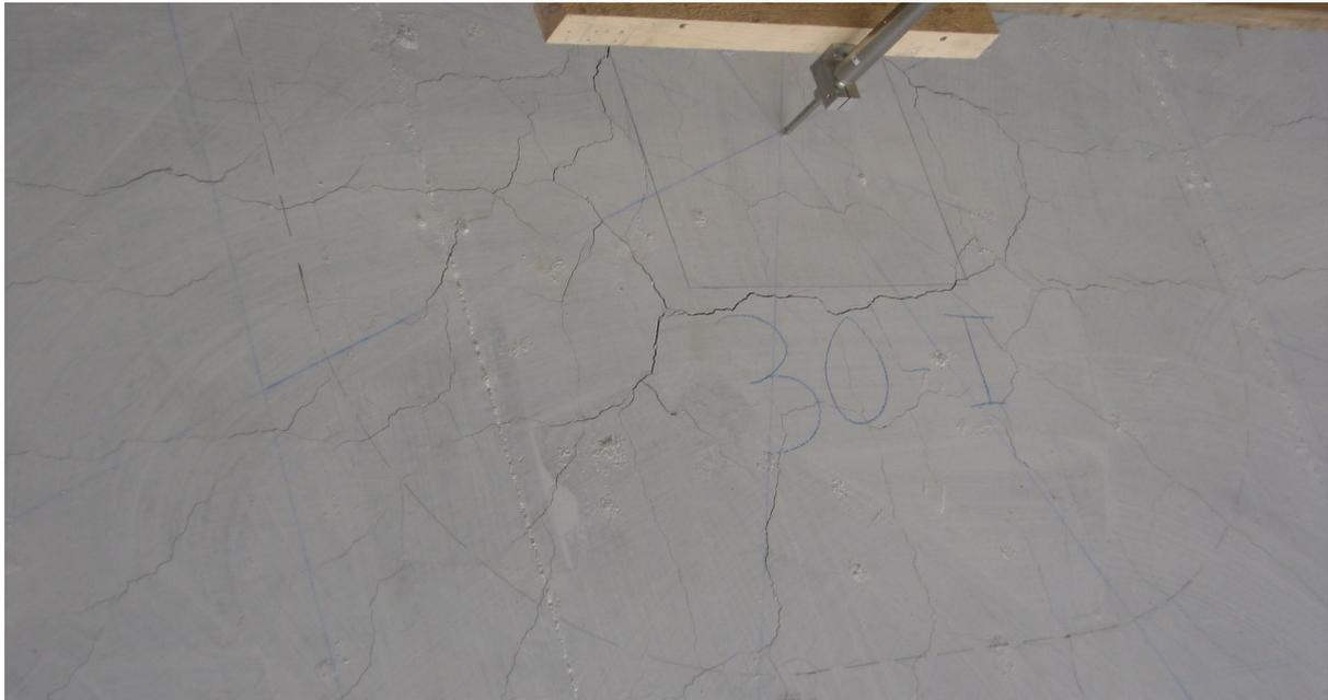
**Bild 5.32:** Risse im Bereich des Stützenstumpfs bei 1.769 kN
