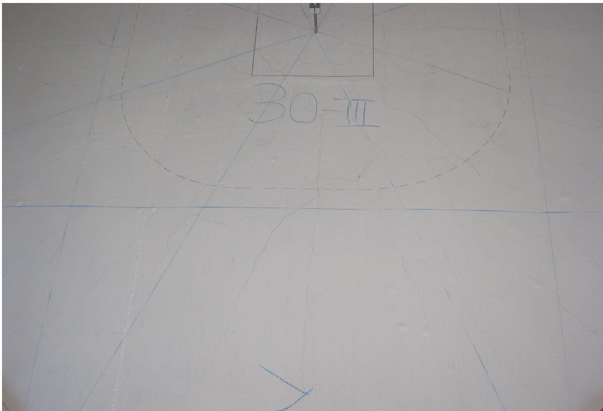
**Bild 5.117:** Rissbild der westlichen Plattenhälfte bei 1.702 kN
