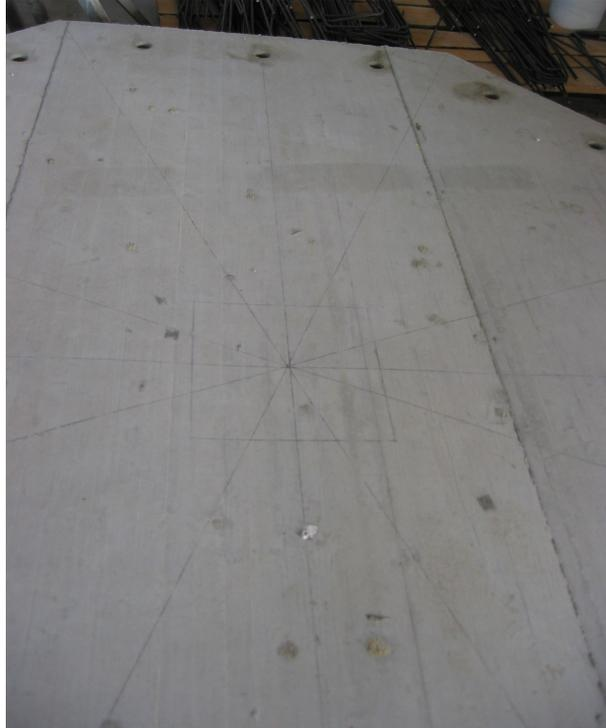
**Bild 4.38:** Auftragen von Mittelpunkt und Stützenumfang auf die Plattenoberfläche
