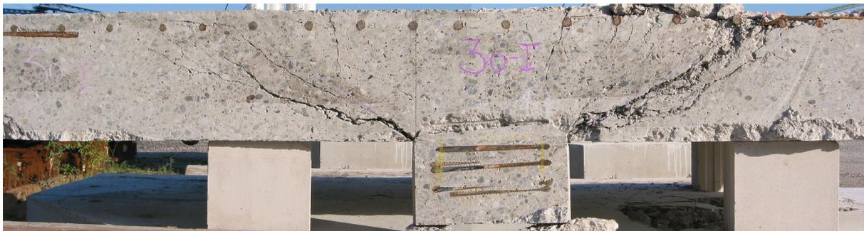
**Bild 5.41:** Plattenquerschnitt nach dem Versagen
