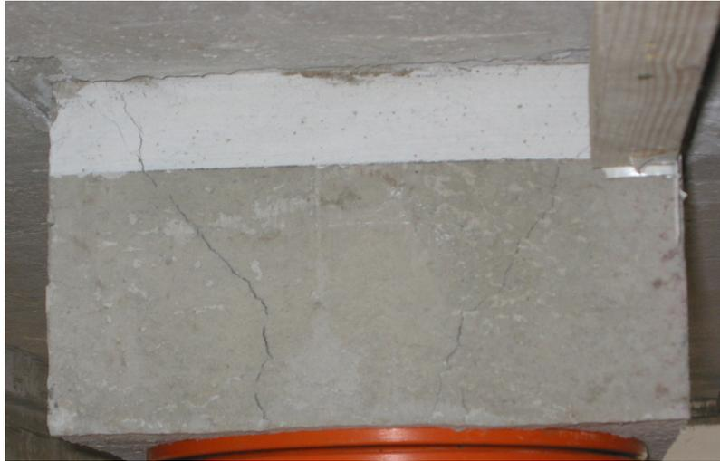
**Bild 4.113:** Krafteinleitungsrisse am Stützenstumpf bei 936 kN
