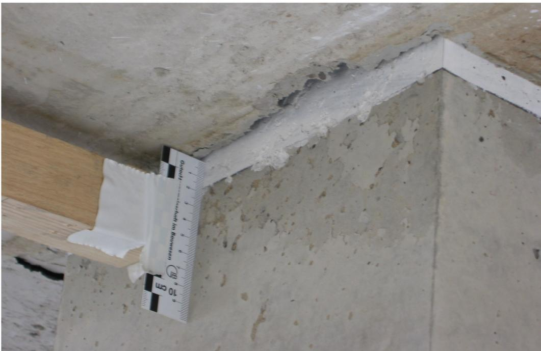
*Bild 4.23:* Messlineal an der Plattenunterseite nach dem Versagen
