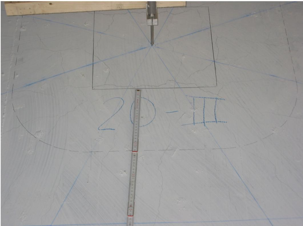
*Bild 4.97:* Rissbild im Bereich des Stützenstumpfs bei einer Last von 600 kN
