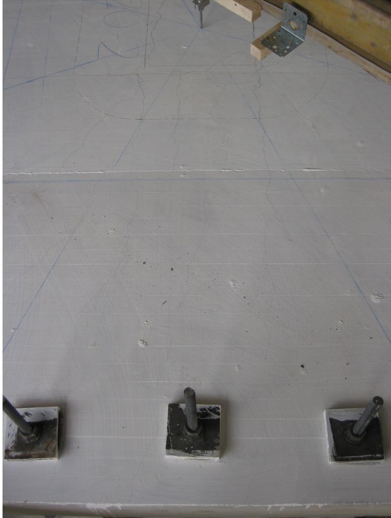
**Bild 4.56:** Risse an der Plattenoberfläche bei einer Last von 746 kN
