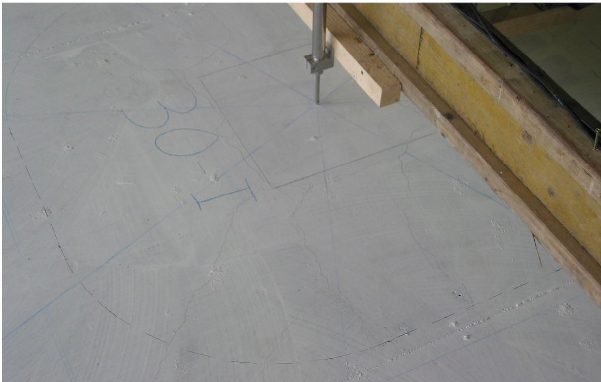
**Bild 5.11:** Rissbild der westlichen Hälfte im Bereich des Stützenstumpfs
