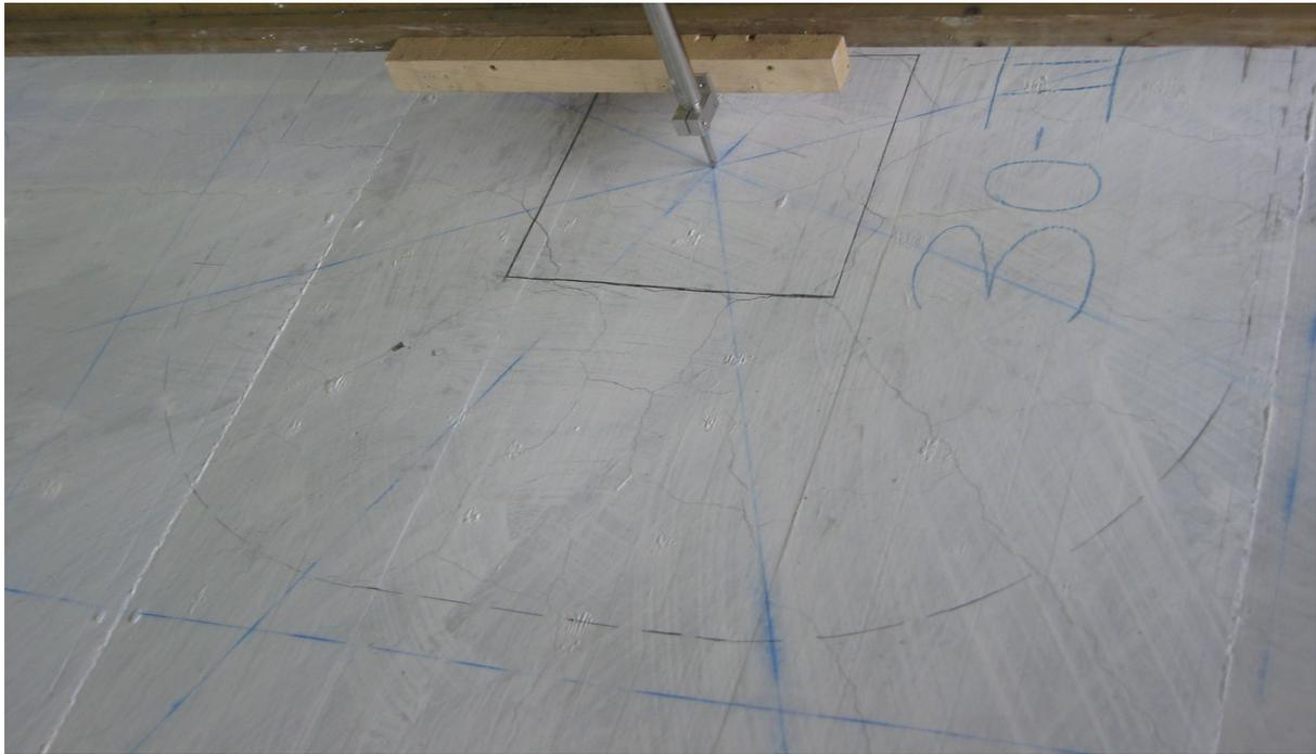
**Bild 5.69:** Risse im nördlichen Bereich des Stützenstumpfs bei 1.488 kN
