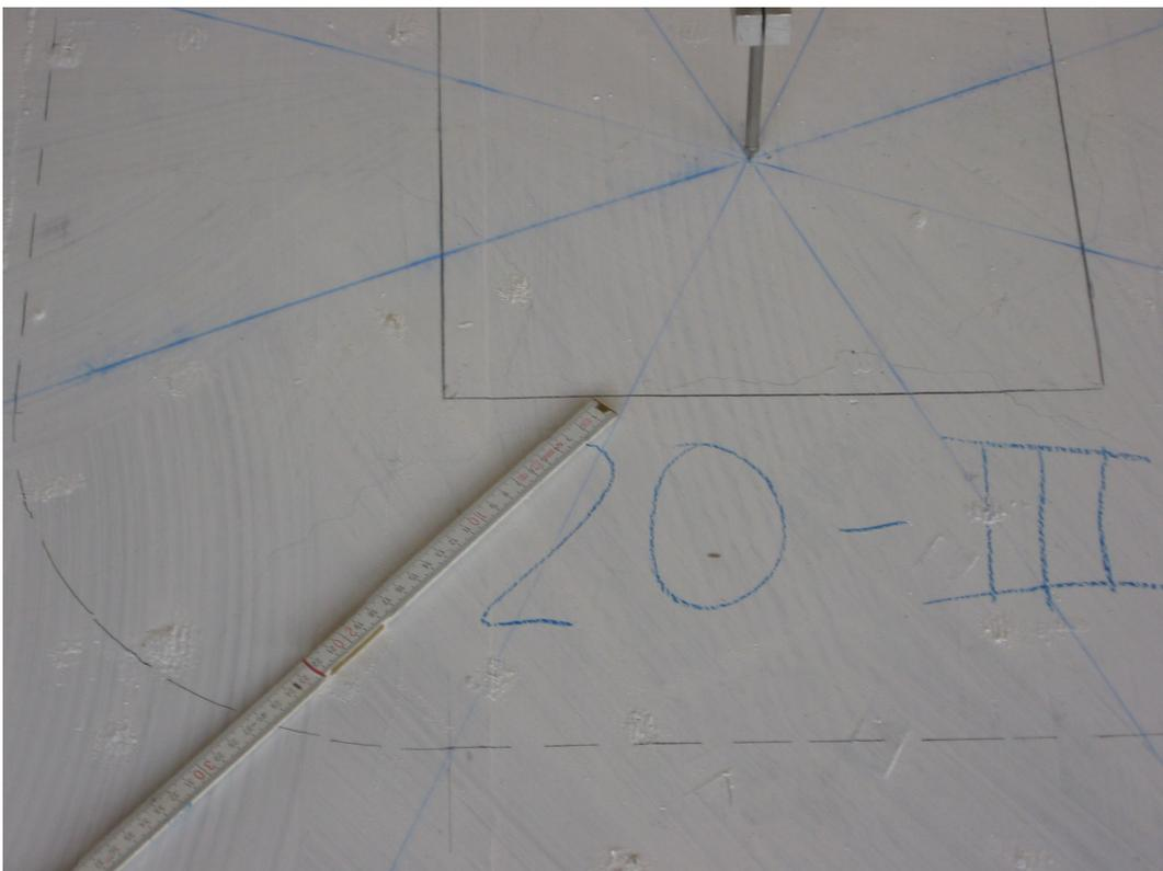
**Bild 4.90:** Haarrisse im Bereich des kritischen Rundschnitts bei einer Last von 300 kN
