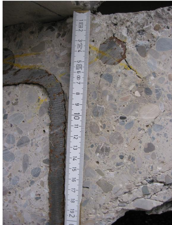
*Bild 4.137:* Messen der maximalen Risstiefe an der Schnittfläche der Platte 20-III
