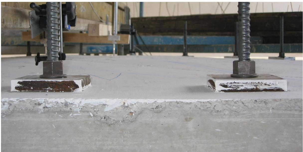
*Bild 4.69:* Wölbung der Plattenoberseite nach dem Versagen
