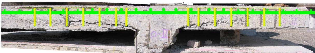
*Bild 4.76:* Schnittfläche der Platte 20-II mit eingezeichneter Biege- und Durchstanzbewehrung
