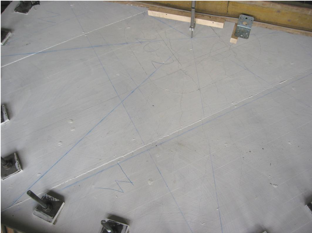
**Bild 4.57:** Rissbild im Bereich des Stützenstumpfs bei einer Last von 800 kN
