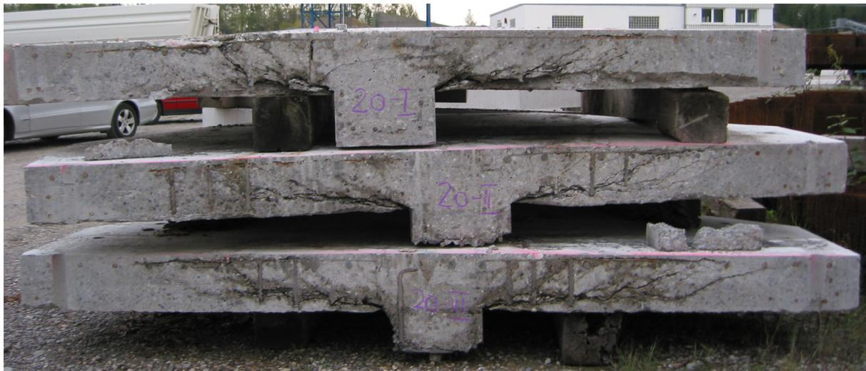
*Bild 4.140:* Schnittflächen der 20 cm starken Versuchsplatten
