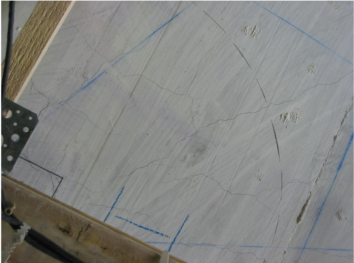
*Bild 5.67:* Risse im süd-westlichen Sektor bei 1.389 kN
