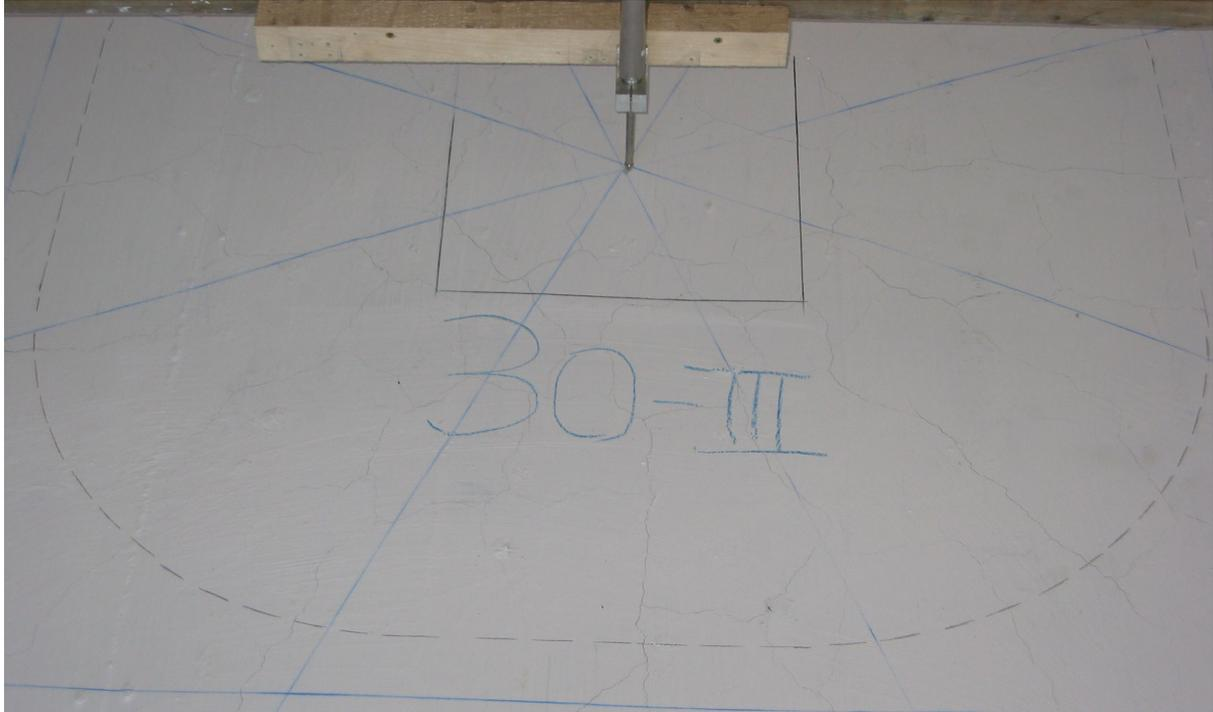
*Bild 5.109:* Westliche Plattenhälfte im Bereich des Stützenstumpfs bei 1.497 kN
