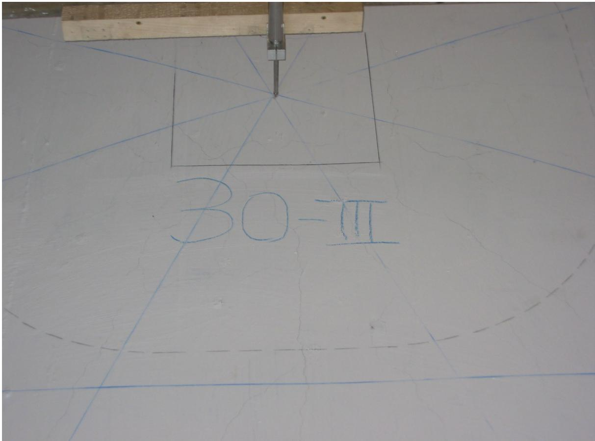
**Bild 5.106:** Rissbild der westlichen Plattenhälfte bei der Last von 1.299 kN
