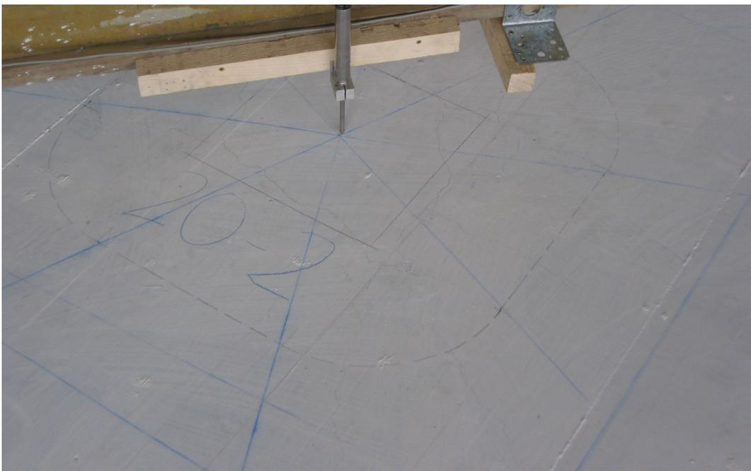
**Bild 4.49:** Rissbild im Bereich des Stützenstumpfs bei einer Last von 491 kN
