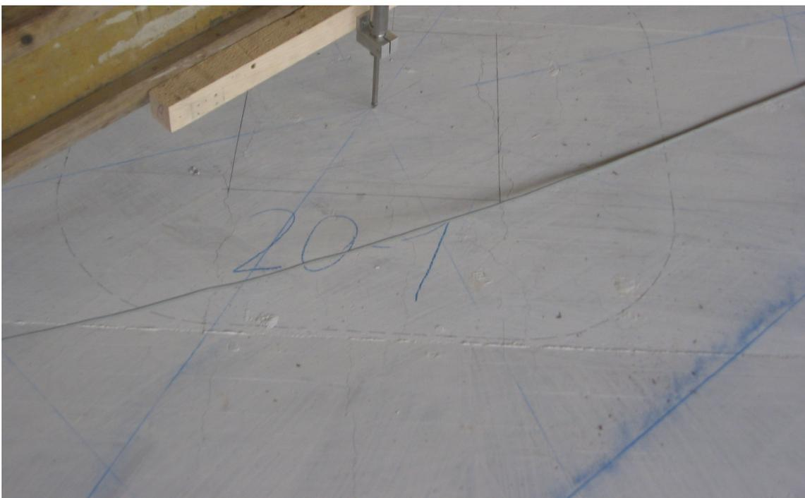
**Bild 4.15:** Risse im Stützenbereich bei 375 kN
