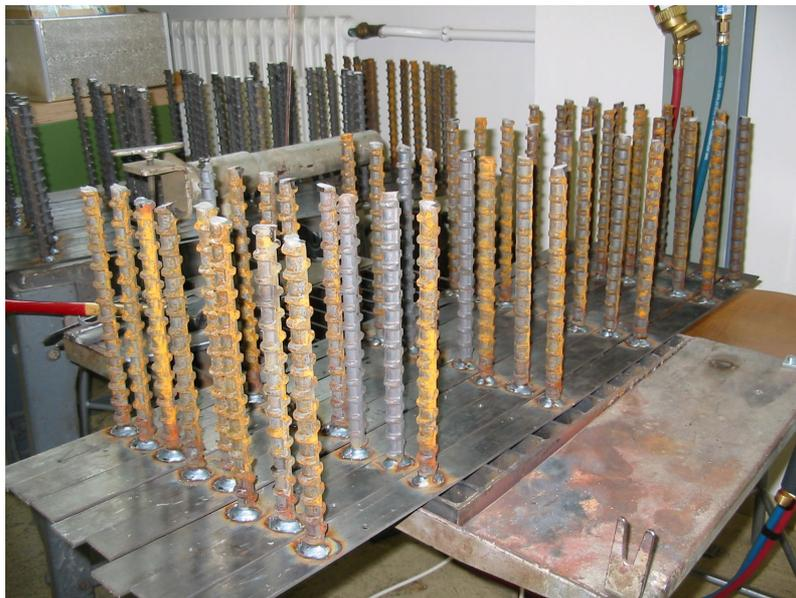
**Bild 3.19:** HFV-Ankerleisten für die 30 cm starken Durchstanzplatten
