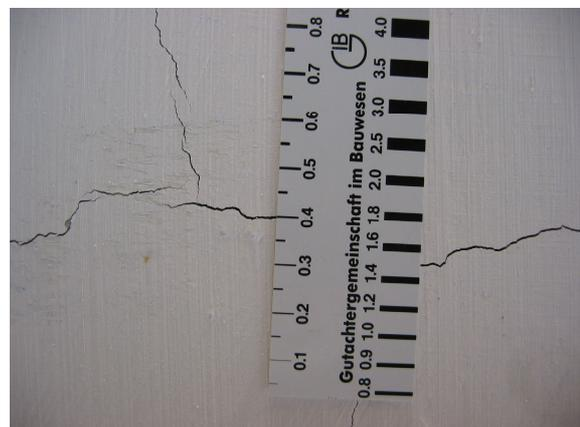
**Bild 5.108:** Gemessene Rissweiten im Bereich des Stützenstumpfs bei 1.395 kN
