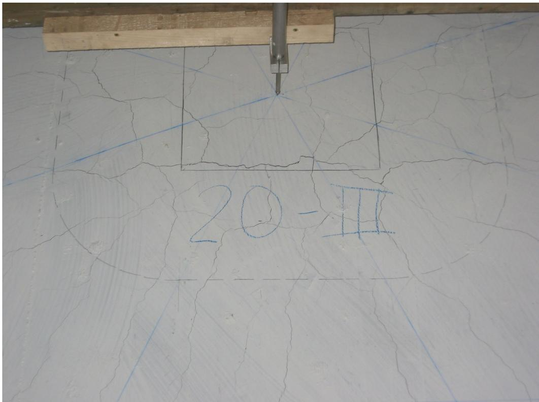
*Bild 4.121:* Rissbild an der Plattenoberfläche bei 1.031kN
