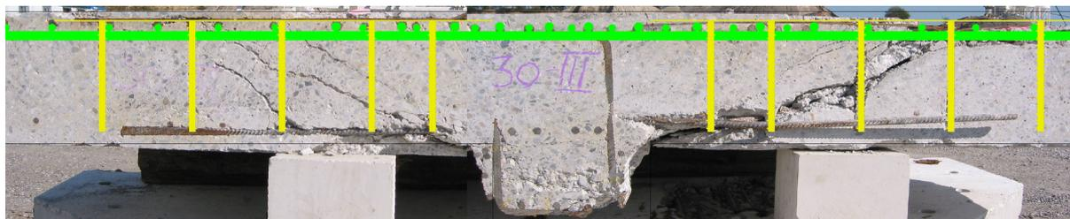
**Bild 5.141:** Schnittfläche mit eingezeichneter Biegebewehrung und HFV-Anker
