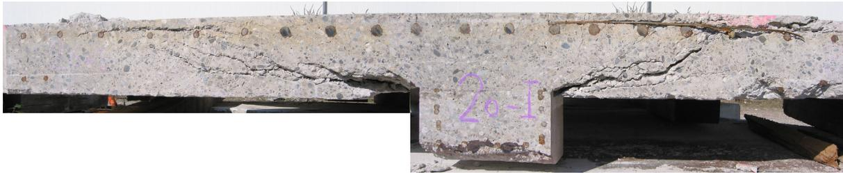
**Bild 4.29:** Plattenquerschnitt nach der Versuchsdurchführung
