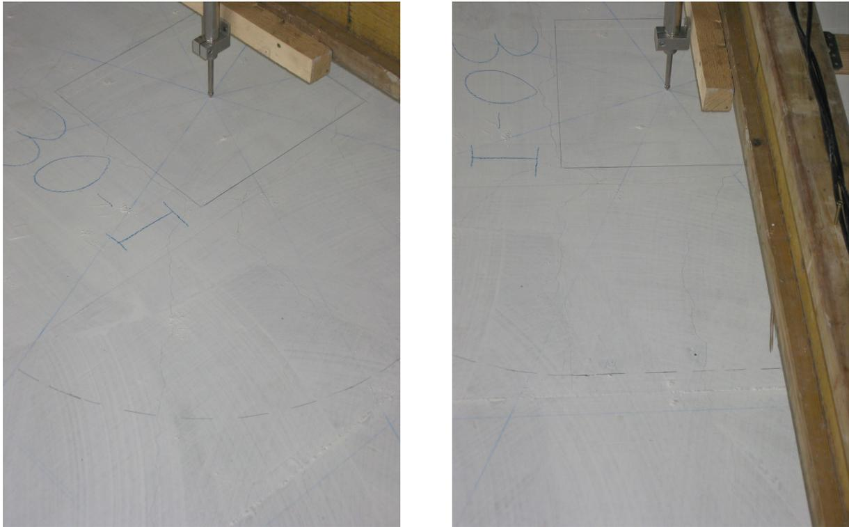
**Bild 5.8:** Stützenbereich bei der Last von 703 kN im Süd-West- und im Süd-Sektor
