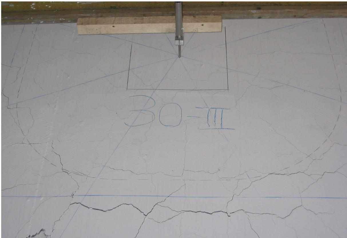
**Bild 5.129:** Westliche Plattenhälfte kurz nach dem Bruch
