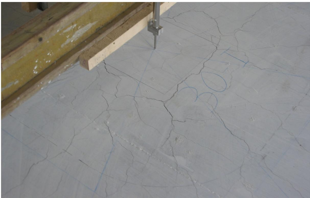
**Bild 5.33:** Rissbild im Bereich des Stützenstumpfs kurz vor dem Versagen der Platte 30-I
