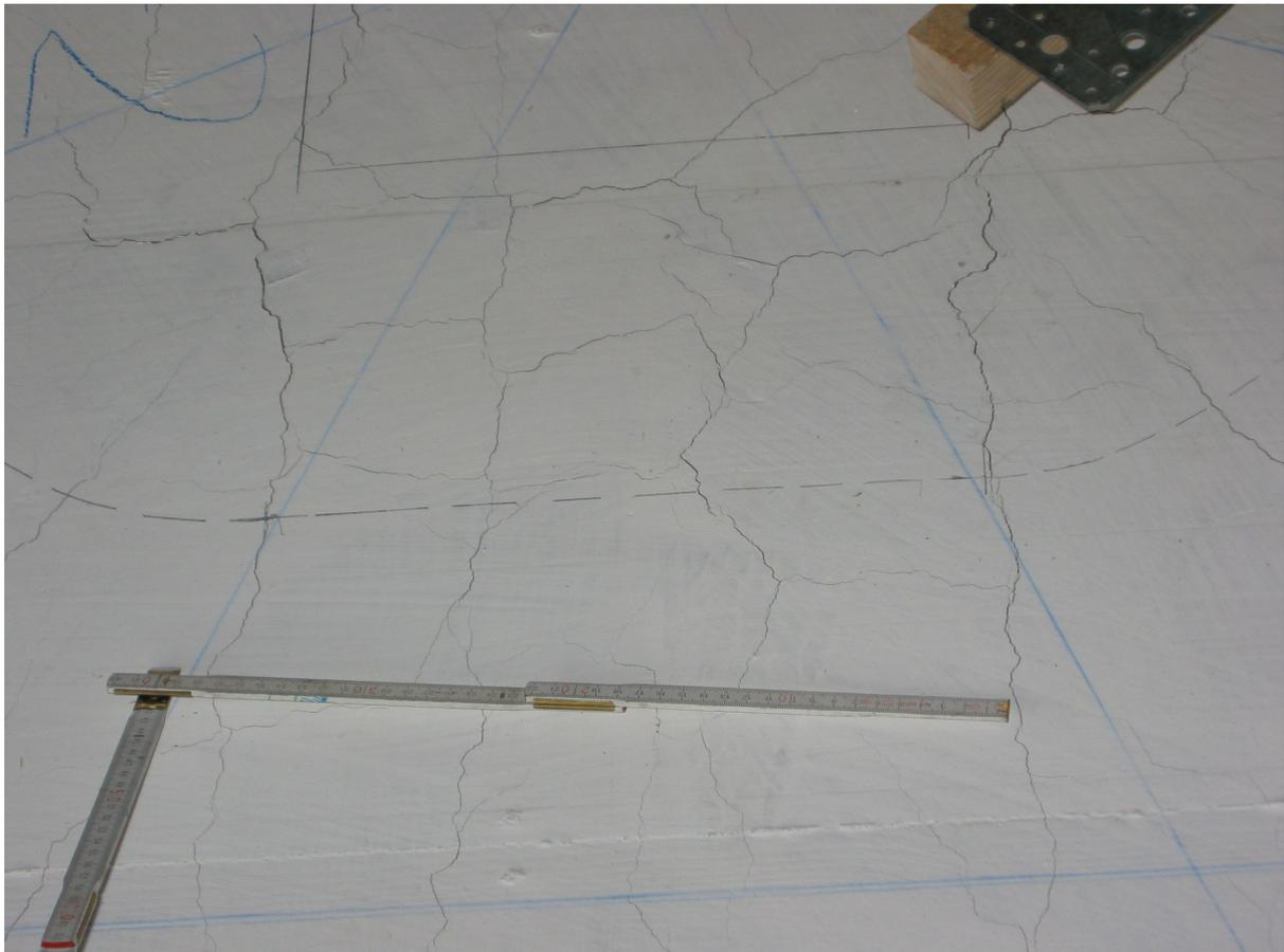
**Bild 6.6:** Rissbild im Bereich des kritischen Rundschnitts bei etwa 90 % der Bruchlast
