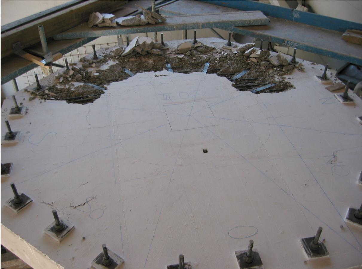
Bild 5.138: Gesamte Versuchsplatte nach dem Versagen
