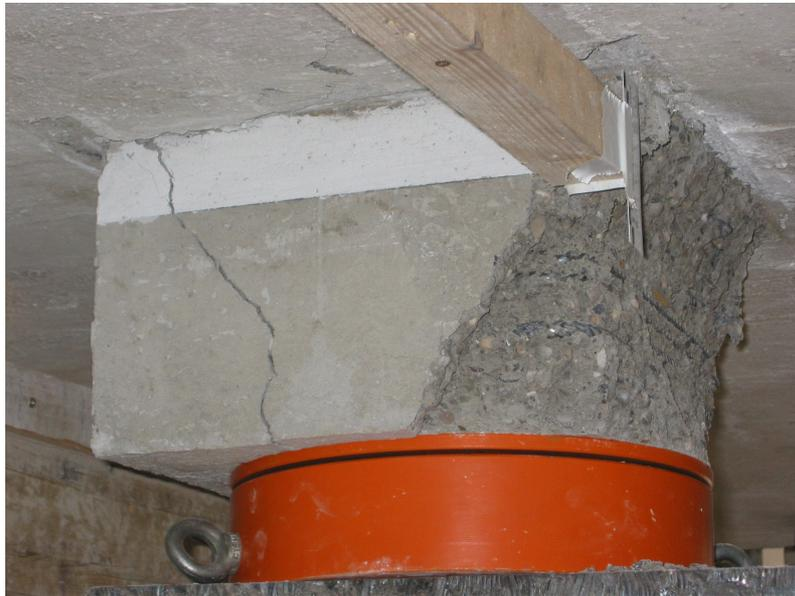
*Bild 4.124:* Stützenstumpf nach dem Versagen der Versuchsplatte
