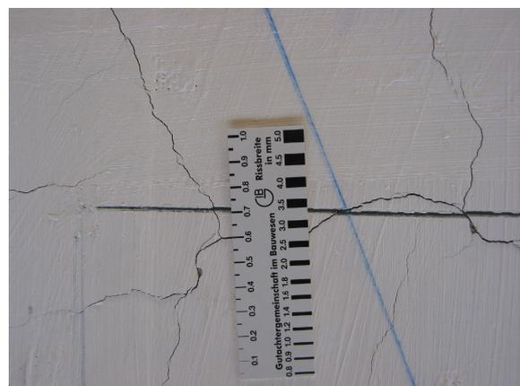
**Bild 5.119:** Gemessene Rissweiten im Bereich des Stützenstumpfs bei 1.776 kN
