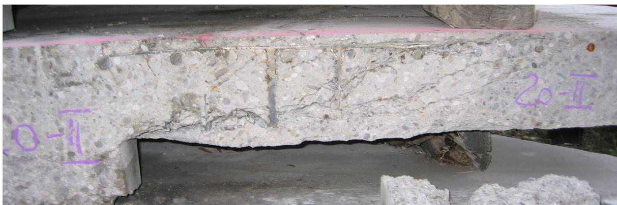
**Bild 4.81:** Schnittflächen der Versuchsplatte 20-II
