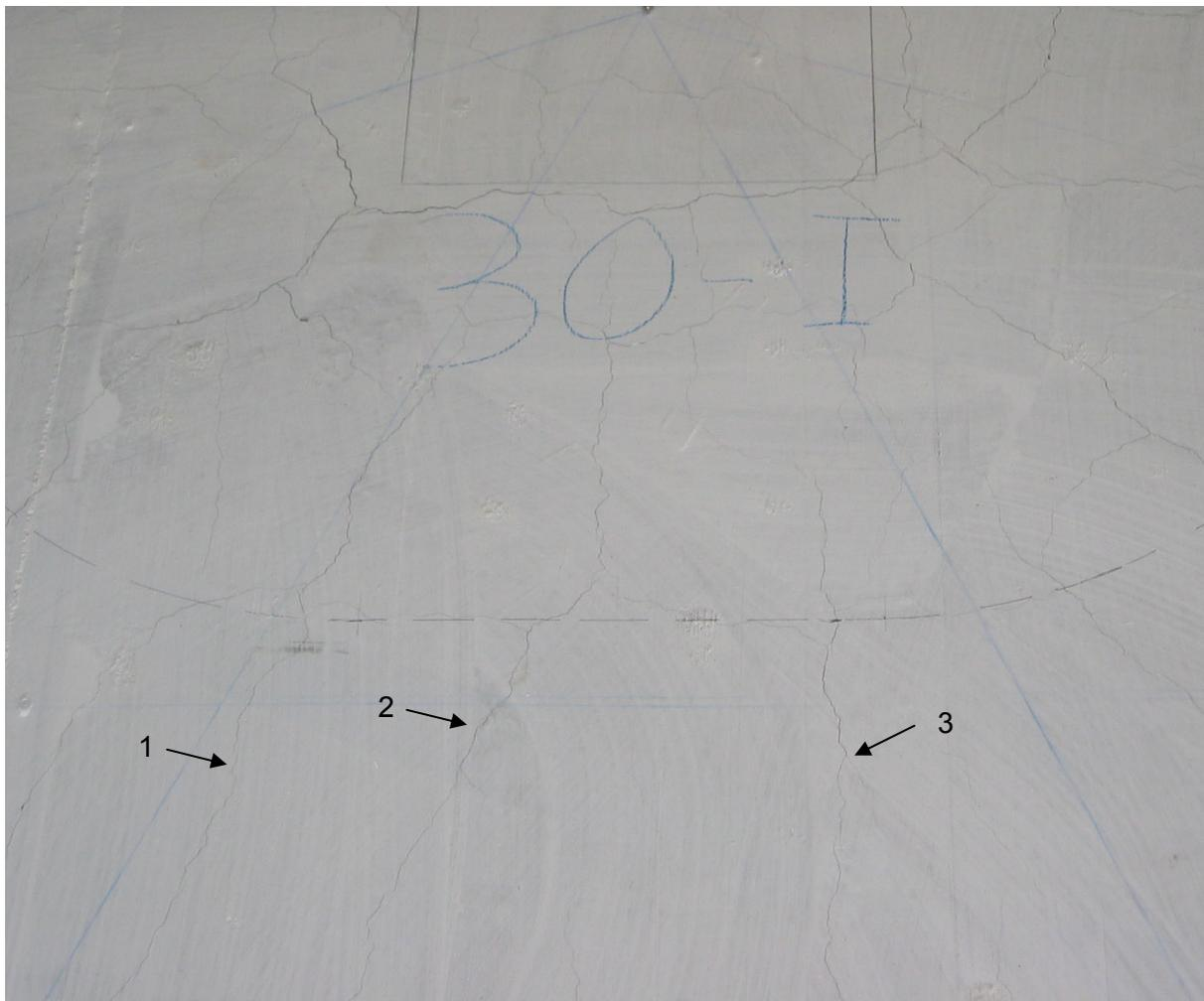
**Bild 6.7:** Darstellung der drei Risse pro Sektor am Beispiel der Platte 30-I
