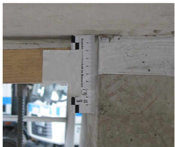
**Bild 4.65:** Maximale Rissweite an der Plattenoberseite und Stützenstumpf an der Plattenunterseite bei einer Last von 1.000 kN
