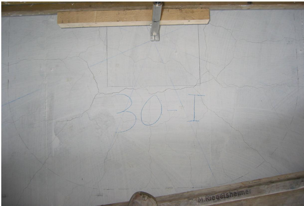
**Bild 5.22:** Risse im westlichen Stützenbereich bei einer Last von 1.285 kN
