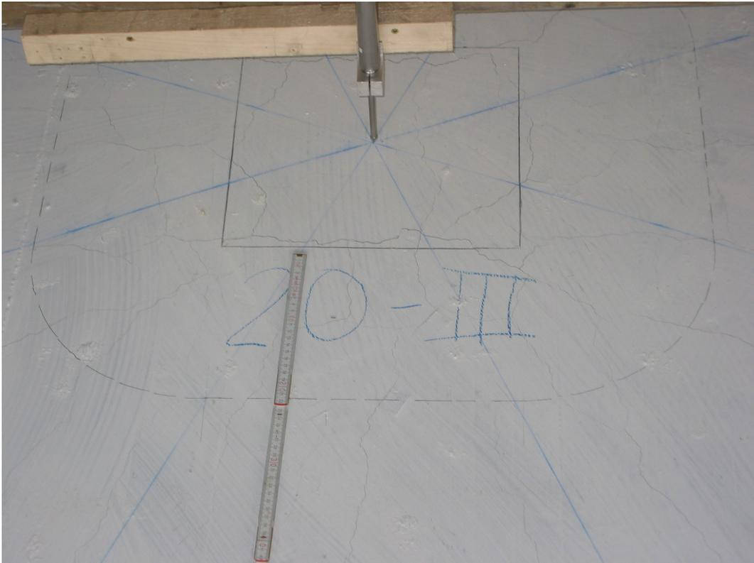
**Bild 4.98:** Rissbild im westlichen Sektor bei einer Last von 648 kN
