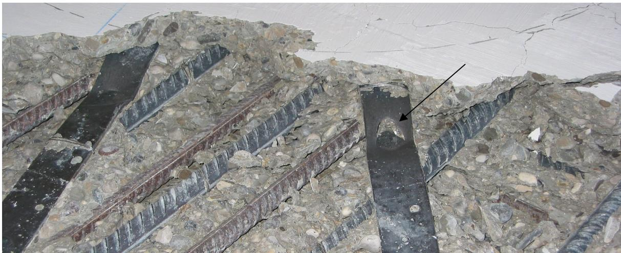
**Bild 5.135:** Versuchsplatte mit teilweise abgelöstem HFV-Anker
