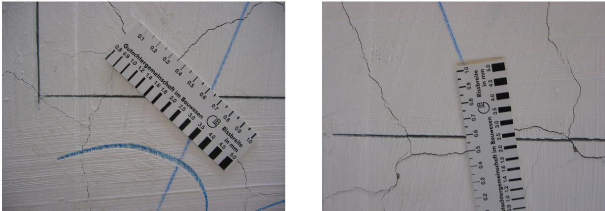
**Bild 5.116:** Gemessene Rissweiten bei einer Last von 1.591 kN im Stützenstumpfbereich
