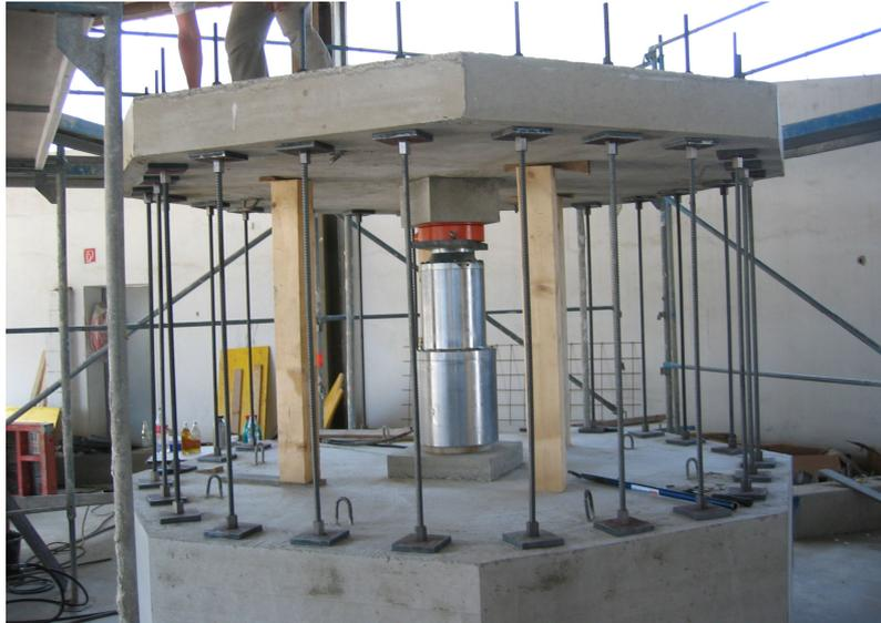
**Bild 4.9:** Versuchsstand mit der Platte 20-I und Hilfskonstruktion
