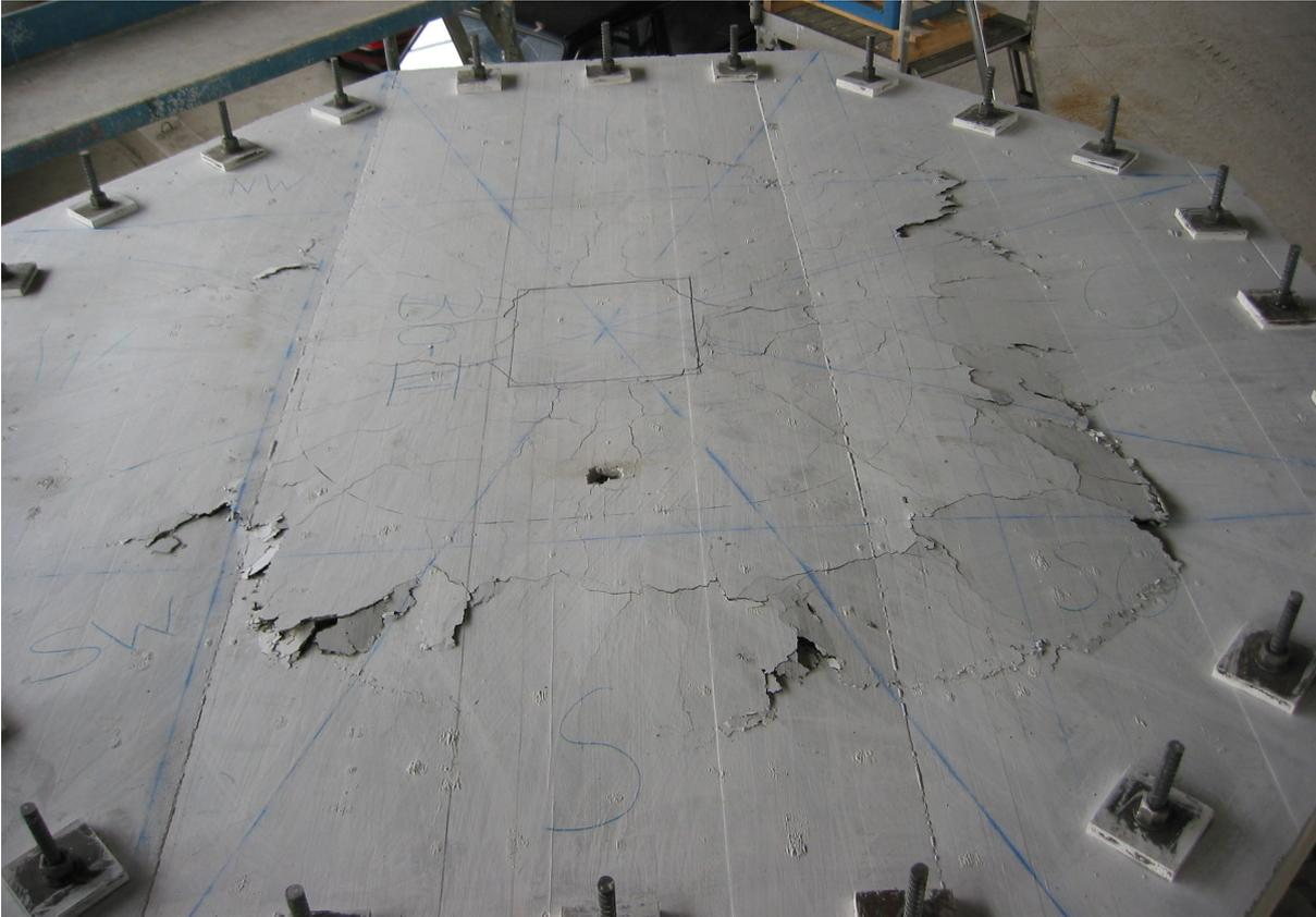
**Bild 5.84:** Plattenoberfläche nach dem Versagen
