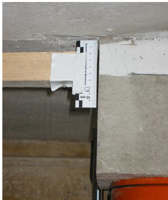
**Bild 4.110:** Stützenstumpf an der Plattenunterseite bei einer Last von 850 kN
