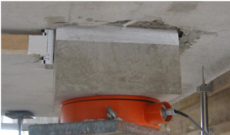
*Bild 4.67:* Bereich des Stützenstumpfs an der Plattenunterseite nach dem Versagen
