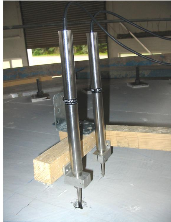
*Bild 5.5:* Angebrachte Wegaufnehmer an der Plattenoberfläche
